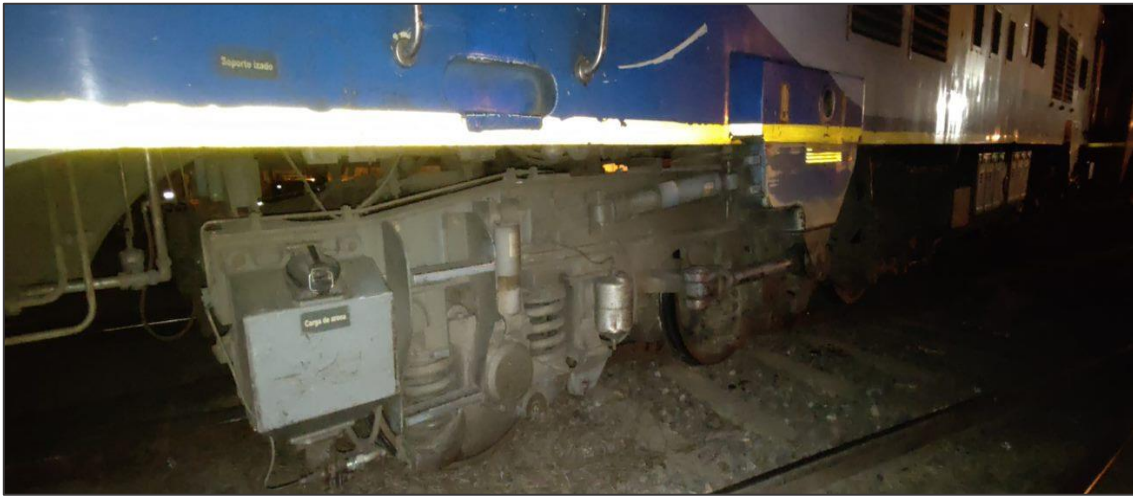
Figura 5. Coche descarrilado. Fuente: JST, 2022
