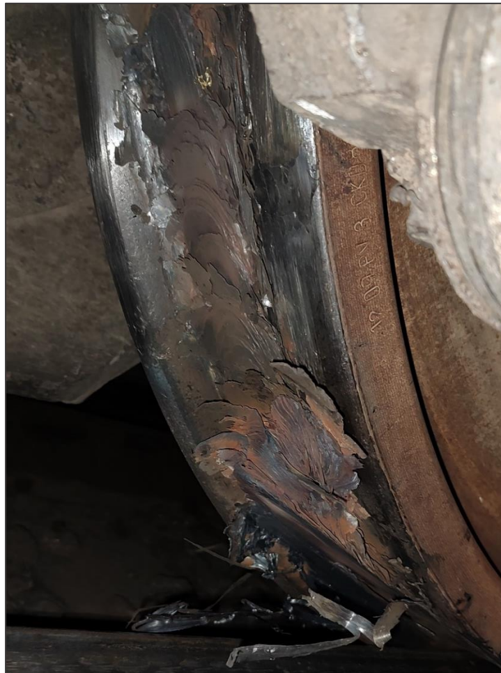
Figura 6. Banda de rodadura con daños de importancia. Fuente: JST, 2022
