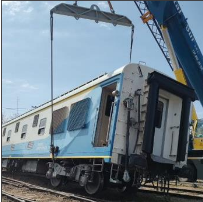
Figura 2. Tareas de encarrilamiento. Fuente: JST, 2022
