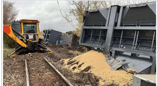
Fig. 2. Pérdida de carga de los contenedores graneleros y trabajos en la vía
