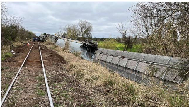
Fig. 3. Tolvas descarriladas y tumbadas sobre el lateral de la vía
