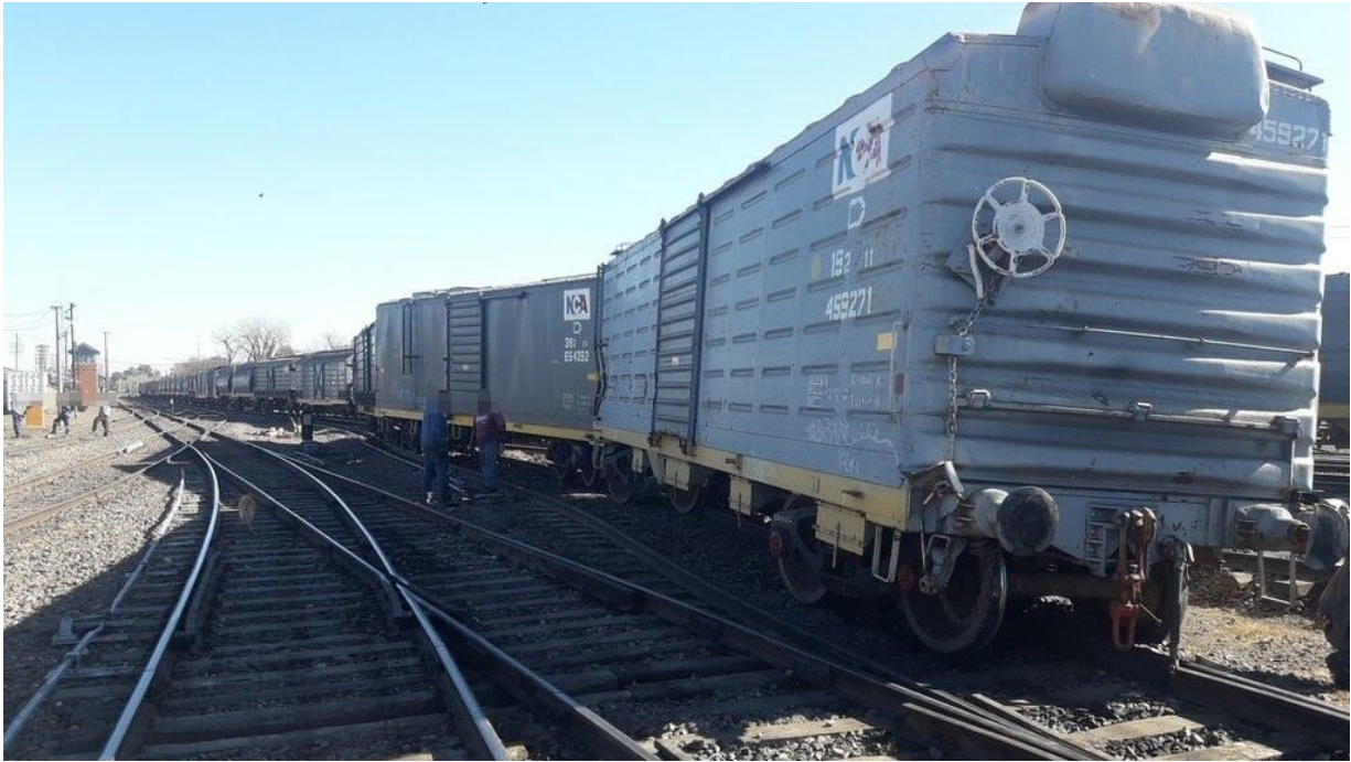
Figura 4. Parte de la formación descarrilada con el vagón 459271 a la cabeza. Fuente: JST, 2022
