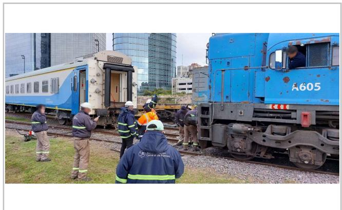
Fig. 4. Locomotora A605 encarrilando el coche CPA 038
