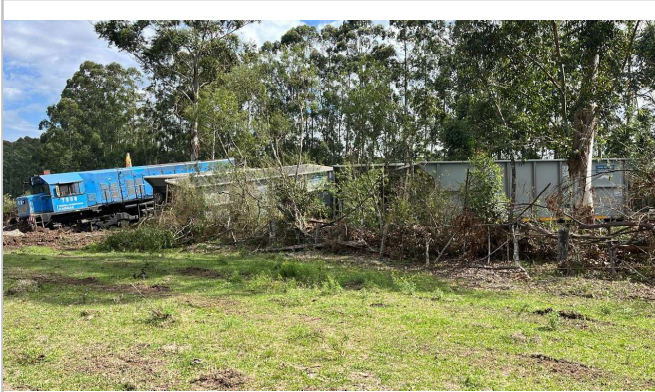
Fig. 1. Vista locomotora y vagones descarrilados. Fuente: JST
