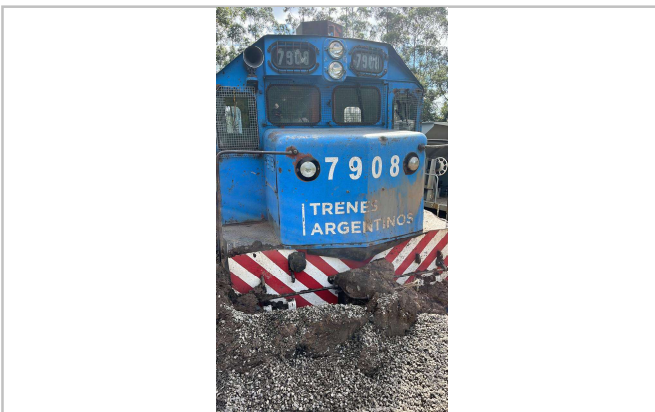
Fig. 3. Vista frontal locomotora descarrilada. Fuente: JST.
