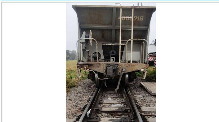
Figura 1. Vagón 4005716 descarrilado en el ADV. JST, 2023
