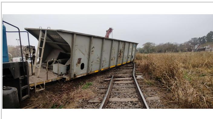
Figura 2. Vagón descarrilado hacia un costado de la vía. JST, 2023
