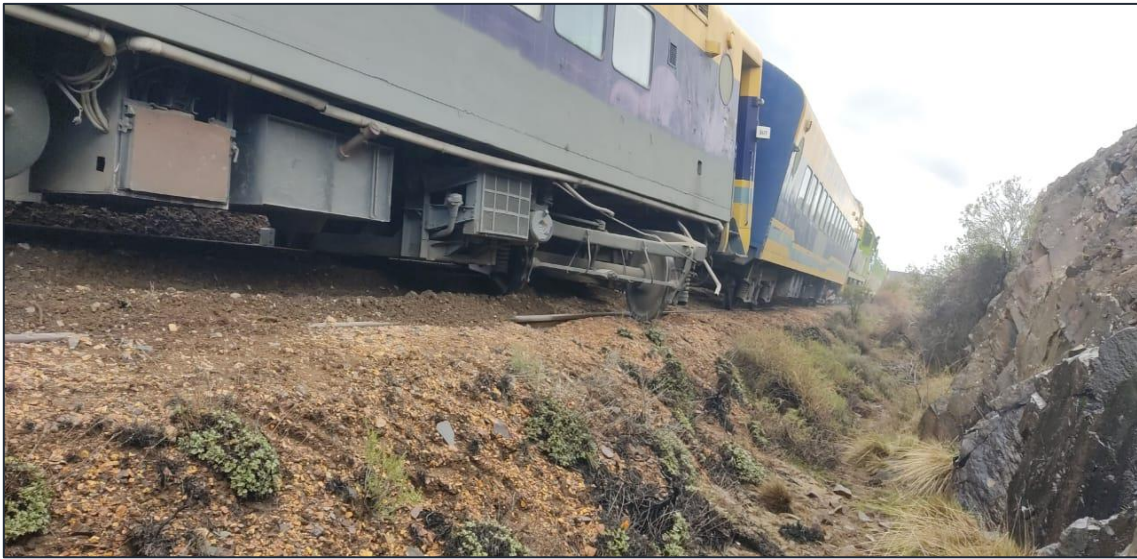
Figura 3. Imagen de uno de los coches descarrilados. Fuente: JST, 2023
