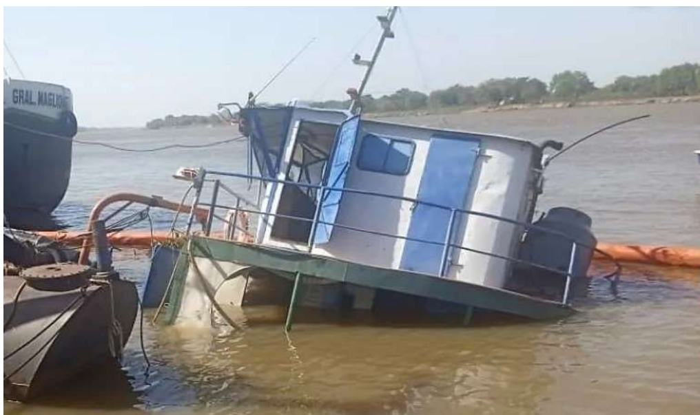
Figura 4. Buque hundido y barrera de contención visto por su banda de babor a la altura del casillaje
