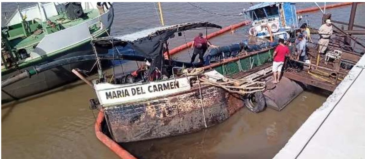
Figura 6. Buque hundido y barrera de contención visto por la amura de babor. Se observa una manguera de asistencia proveniente del Buque Gral Maglione
