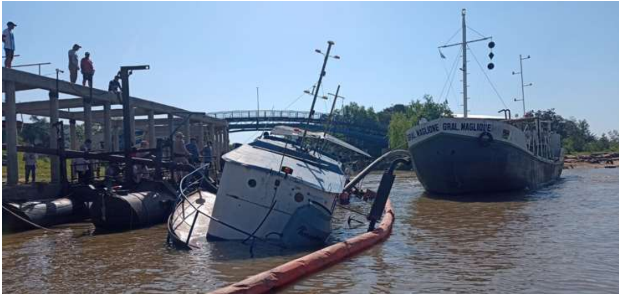
Figura 5. Buque hundido y barrera de contención visto de popa. Se observa una manguera de asistencia provista por el buque Gral. Maglione
