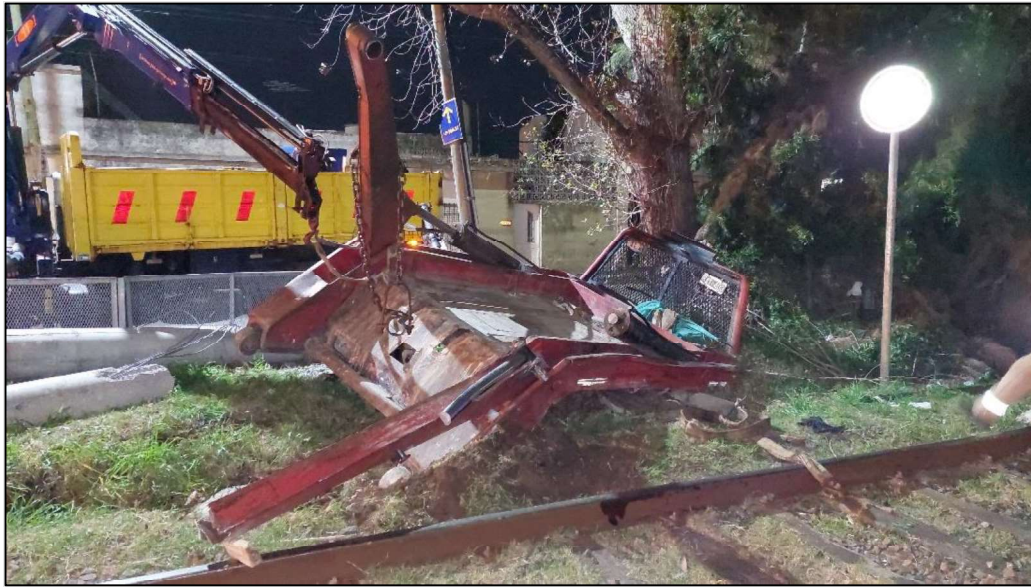
Figura 4. Estado de brazos portavolquetes postcolisión. Fuente JST, 2023
