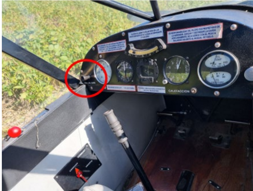
Figura 6. Comando de aire caliente al carburador en posición frío. Fuente: investigación JST
