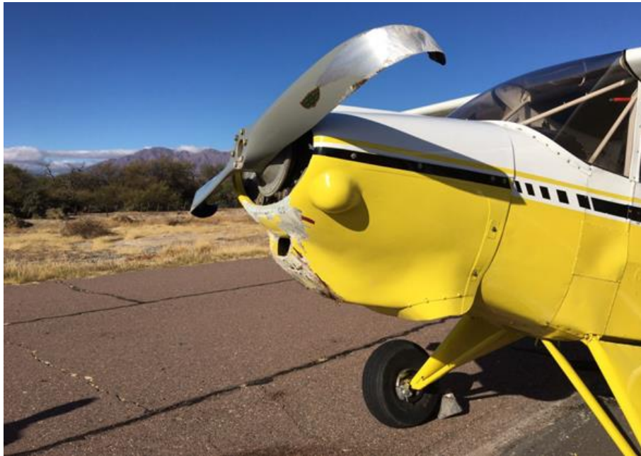
Figura 3. Deformación de las palas de la hélice. Fuente: investigación JST
