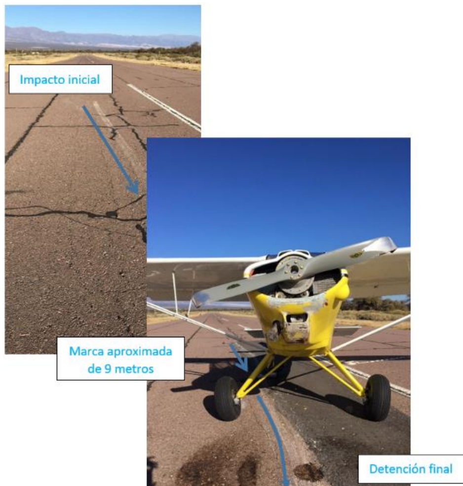
Figura 2. Marcas en la superficie de pista. Fuente: investigación JST
