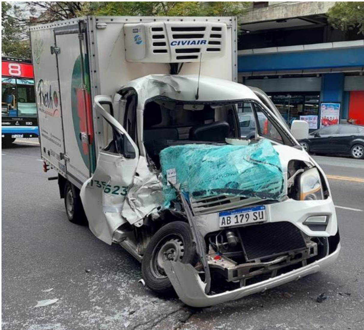
Figura 7: Daños producidos en el choque con el Vehículo 2. Fuente: JST, 2023
