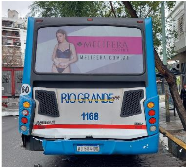
Figura 9: Daños producidos en el Vehículo 2 en el impacto con el Vehículo 1. Fuente: JST, 2023
