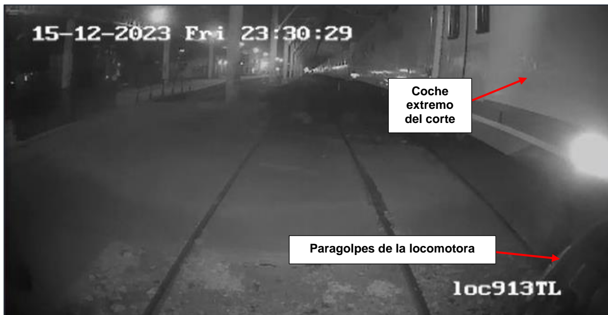
Figura 1. Locomotora A913 y corte de coches en contacto, luego del suceso. Fuente: SOFSE, 2024
