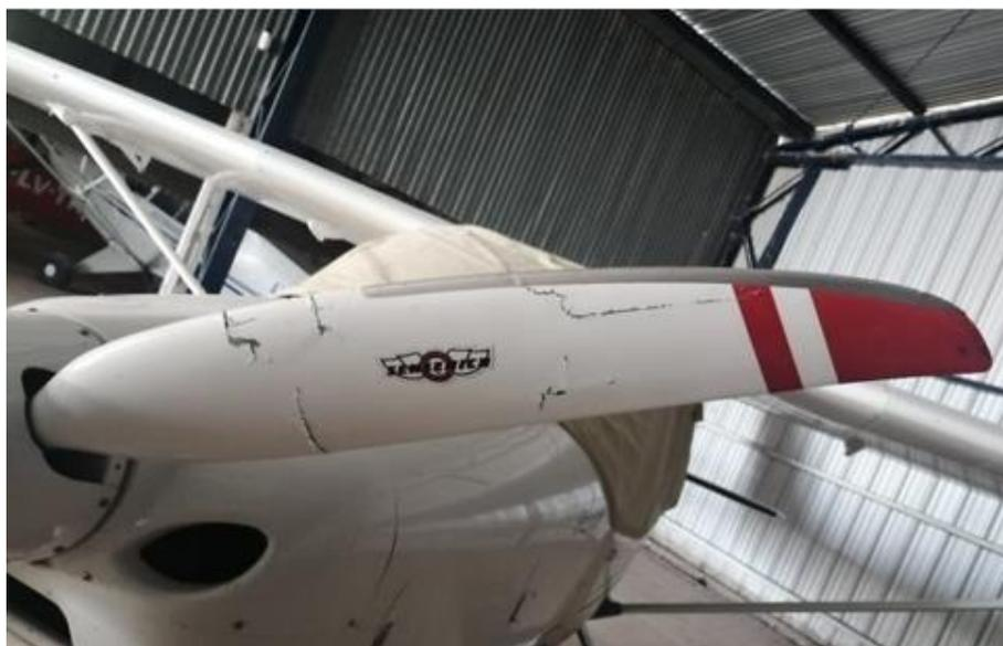
Figura 1. Daños en la pala N°1 de la hélice. Fuente: investigación JST
