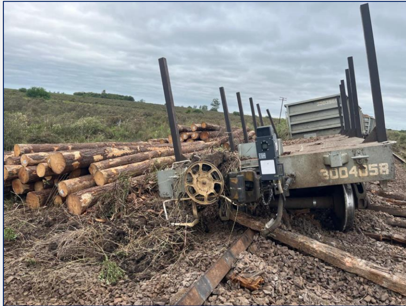
Figura 1. Vagones descarrilados del tren A30 con pérdida de carga. Fuente: JST, 2024
