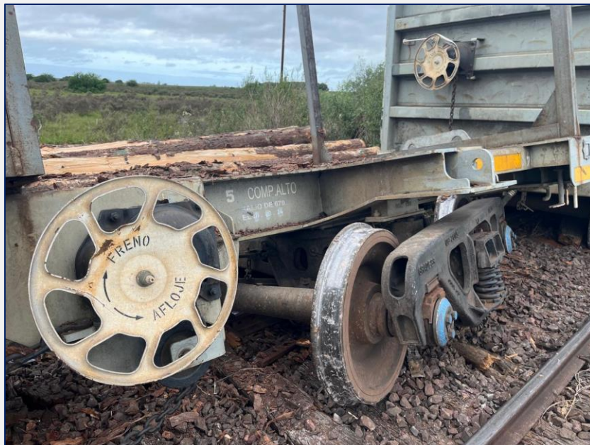
Figura 2. Bogies y freno de afloje afectados. Fuente: JST, 2024
