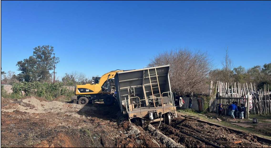
Figura 5. Estado de la superestructura de vía luego del descarrilamiento.
