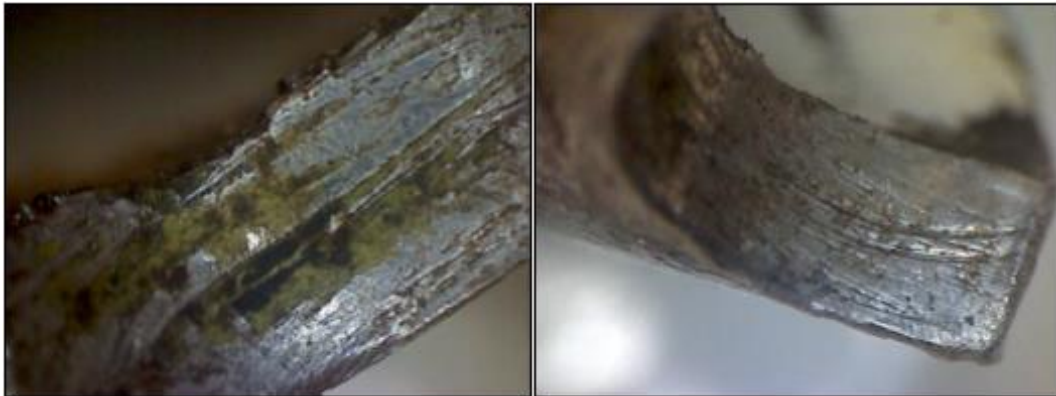
Figura 17. 1) marcas con restos de primer , 50X. 2) marcas con óxidos y corrosión, 50X. Fuente: investigación JST
