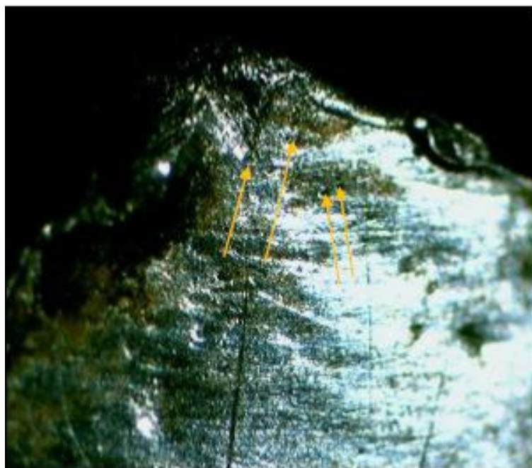
Figura 16. Vista lateral Tramo A con pitts de corrosión, 200X. Fuente: investigación JST
