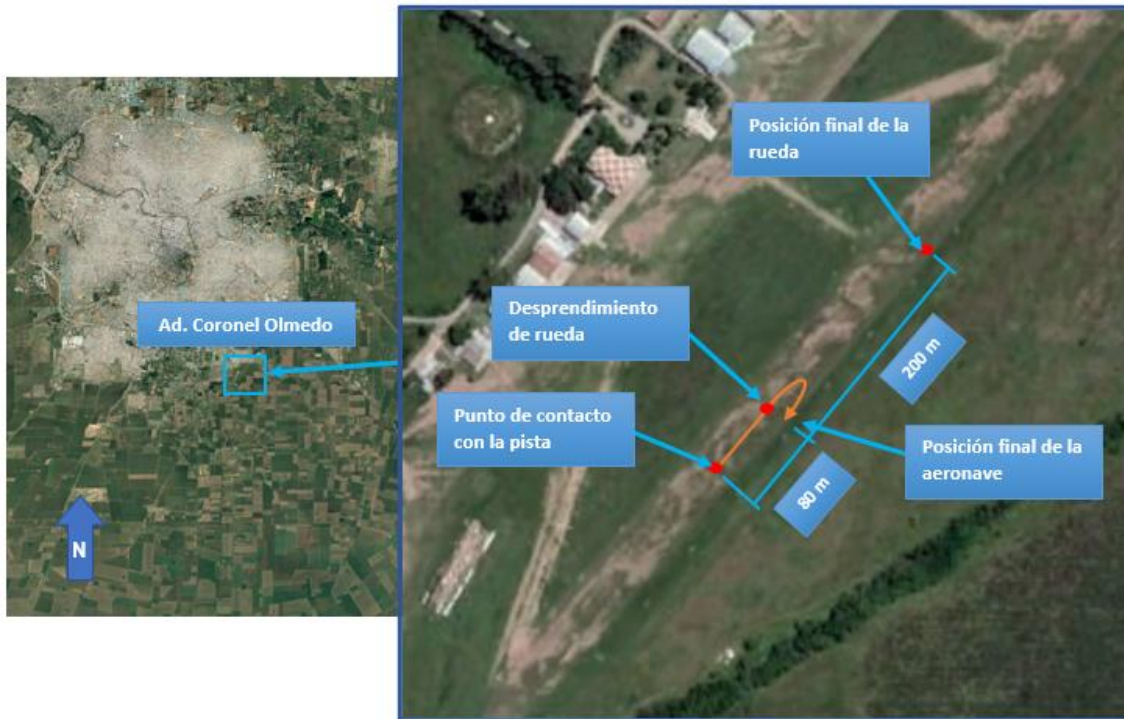
Figura 4. Lugar del suceso y trayectoria de la aeronave sobre la pista. Fuente: investigación JST
