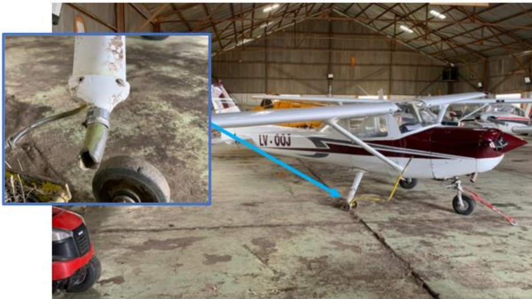
Figura 2. Vista del daño en tren de aterrizaje principal derecho. Fuente: investigación JST
