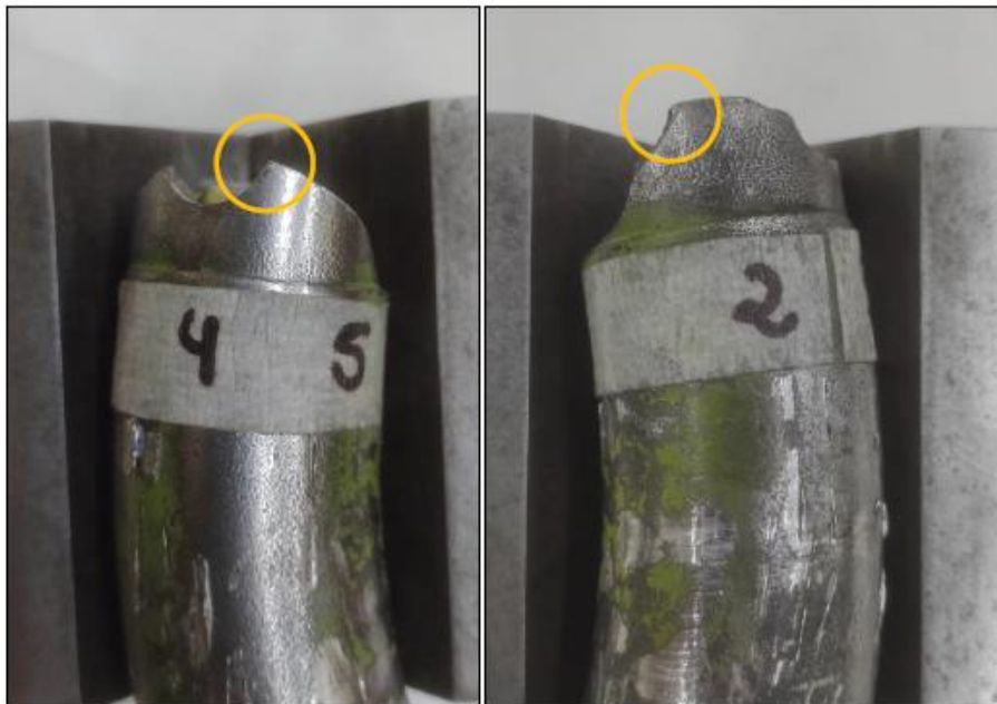
Figura 10. 1) Zona de inicio 1 de fractura, tramo A. 2) Zona de inicio 2 de fractura, tramo A. Fuente: investigación JST
