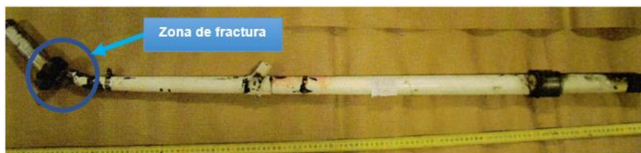
Figura 22. Fleje tubular de aeronave LV-OJF con similar fractura. Fuente: investigación JST
