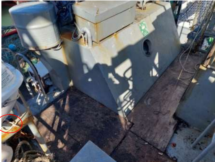
Figura 13. Superestructura a popa de la timonera. Lugar de estiba de las botellas de agua. Se observan las planchas de madera sobre el piso de metal. Se destaca en un círculo rojo la boza de una de las dos balsas que estaba hecha firme en una parte estructural del buque, en lugar de estar conectada con el eslabón débil.
