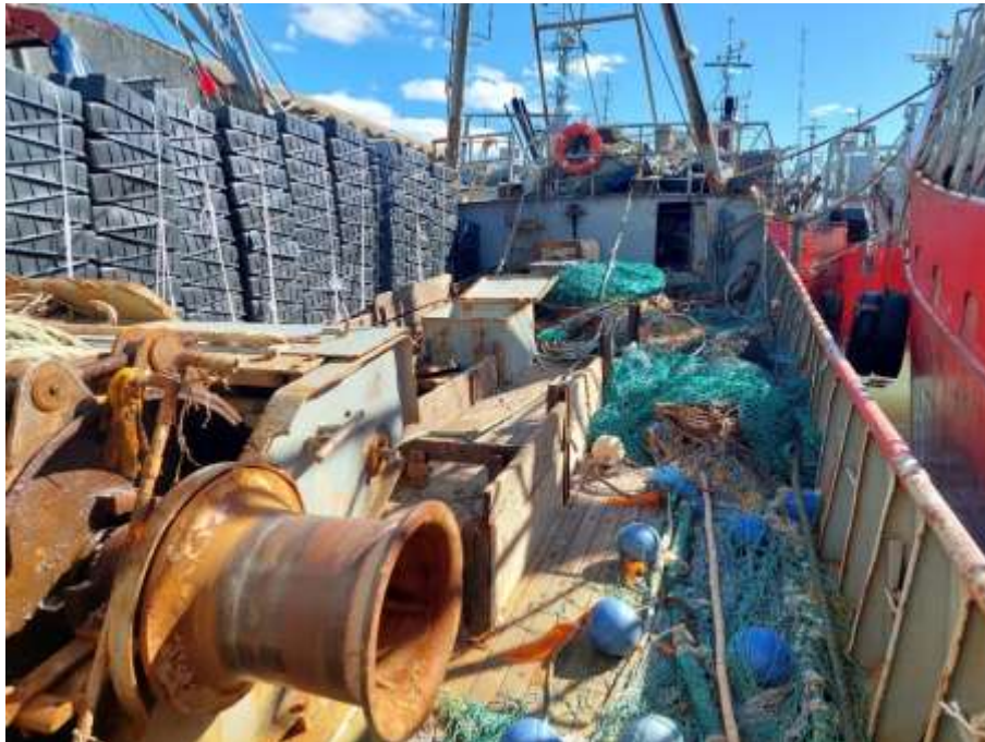
Figura 10. Cubierta principal, vista hacia proa. Se observa la borda sobre la banda de estribor y las redes y cabuyería sobre la cubierta principal.
