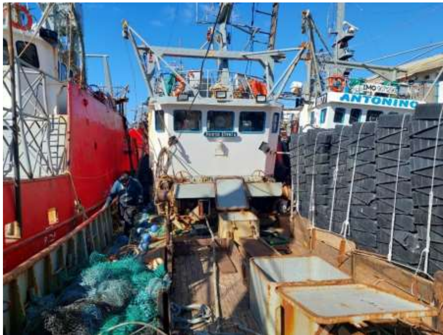
Figura 11. Cubierta principal, vista de proa a popa .Se observa a estribor la borda, las redes y la cabuyería. Sobre babor, se observa una estiba de cajones vacíos.
