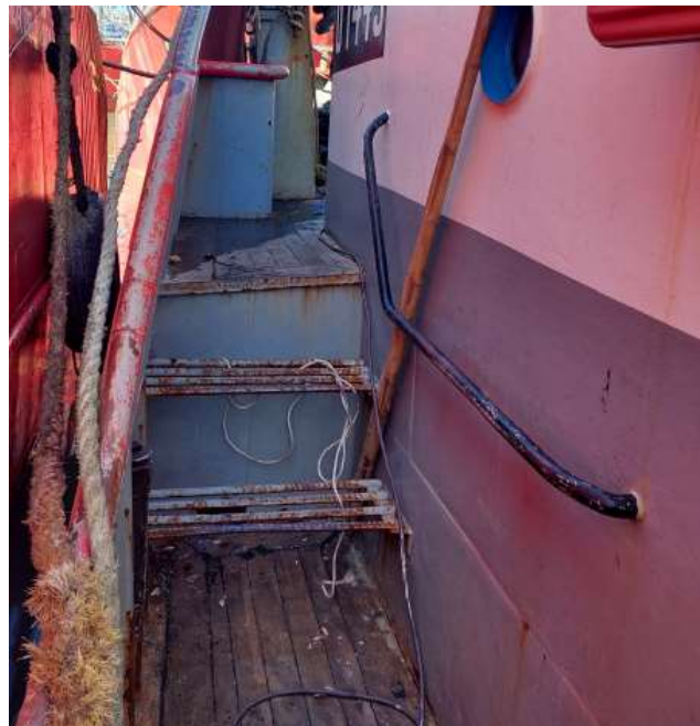
Figura 18. Vista del acceso lateral a la popa de la banda de estribor. Se observa una escalera de dos escalones metálicos, la borda del lado del agua y un pasamanos del lado del casillaje.
