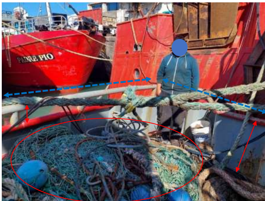
Figura 12. B/P Nuevo Viento. Se observa sobre el espejo de la popa la barandilla de 0,10 m de altura que corona la borda de 0,90 m de alto. Se aprecia además redes y cabuyería sobre la cubierta. El tripulante está de pie en la aleta de babor, su brazo izquierdo da al costado de babor y el derecho al espejo de popa.
