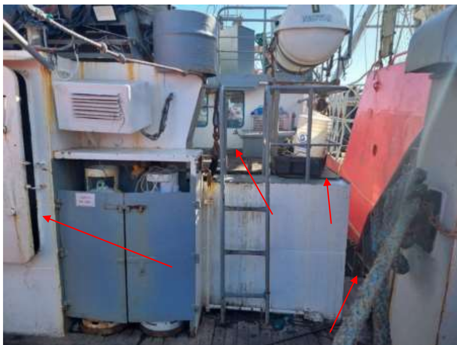
Figura 14. Superestructura a popa de la timonera. Se observa con flechas, de izquierda a derecha, la porta central a popa del casillaje, el lugar de estiba de las botellas de agua, las planchas de madera sobre la cubierta de metal, el accesos a la popa desde la cubierta principal por la banda de estribor.
