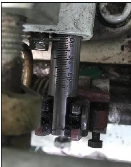
Figura 15. Cremallera de una de las bombas de inyección de combustible 4 . Se detectó que dos cremalleras estaban trabadas
