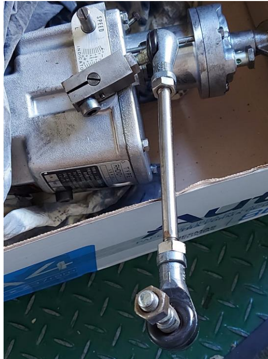
Figura 20. Palanca de salida del regulador espigada, con barra con rotulas y vástago
