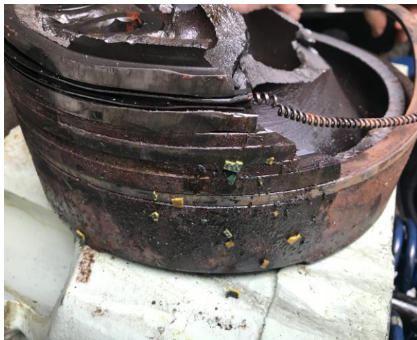
Daño en pistón y aros
