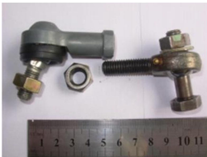
Figura 25. Unión articulada del motor principal de babor, en sus tres partes desarmadas
