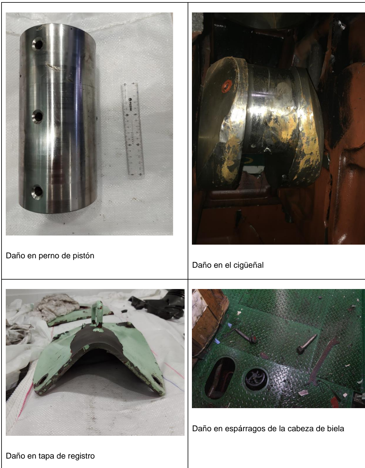
Figura 32. Fotos de los daños materiales en SSMM y M/P de Br
