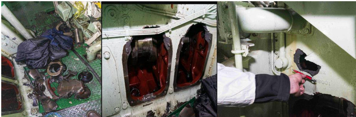
Figura 9. Restos del M/P de Br en SSMM. De izquierda a derecha se observan partes del block y diversos restos a un costado del motor, así como daños en el block del mismo
