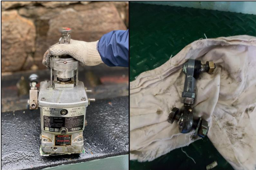
Figura 16. Se muestra de izquierda a derecha el regulador de velocidad y la unión articulada del enlace de control de combustible que fueron requeridos por los investigadores para realizarles ensayos a cargo del laboratorio de la JST
