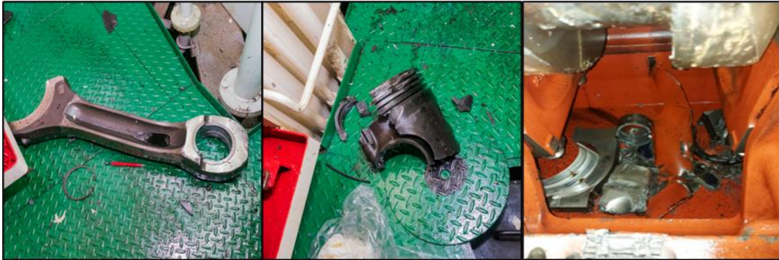
Figura 8. Restos del M/P de Br en SSMM. De izquierda a derecha, se pueden ver una biela, los fragmentos de un pistón dispersos en el suelo y diversos restos dentro del cárter
