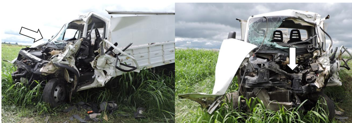
Figura 8. Visualización de daños en la parte anterior del vehículo. Fuente: JST, 2024
