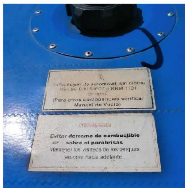
Figura 5. Etiquetas presentes en las bocas de carga de combustible del LV-FUY.
