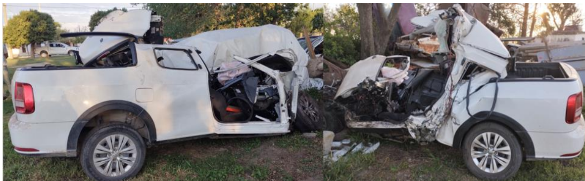
Figura 9. Daños constatados sobre el Vehículo 2 poscolisión. Fuente: JST, 2024
