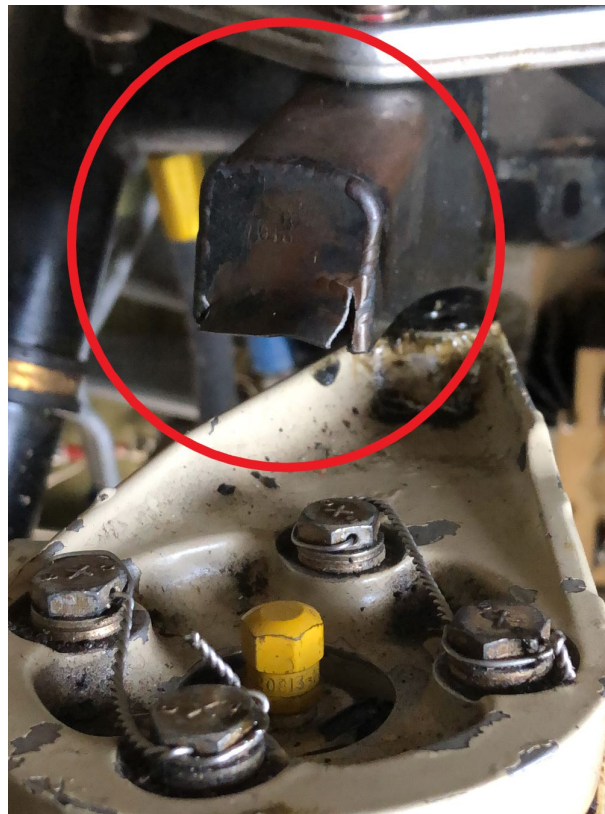
Figura 5. Final de guía dañada. Fuente: investigación JST
