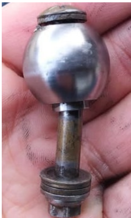
Figura 4. Bulón flexionado. Fuente: investigación JST
