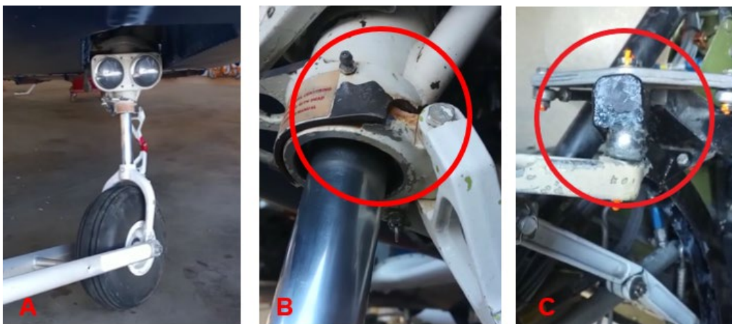
Figura 7. Tren de aterrizaje sobrepasando el límite de giro. Fuente: investigación JST
