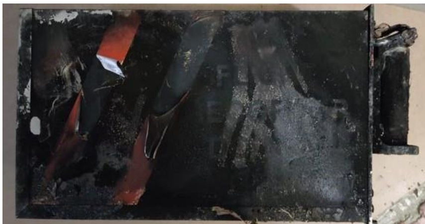
Figura 6. Estado del CVR recuperado. Fuente: investigación JST
