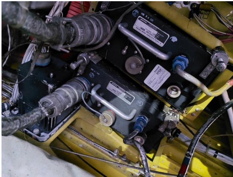
Figura 7. DEEC #1 y DEEC #2 recuperadas de los restos de la aeronave. Fuente: investigación JST
