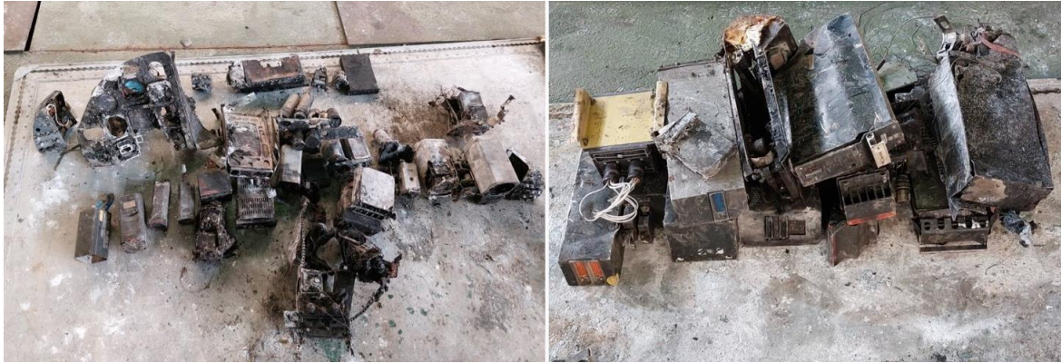
Figura 15. Instrumentos y equipos de cabina recuperados. Fuente: investigación JST
