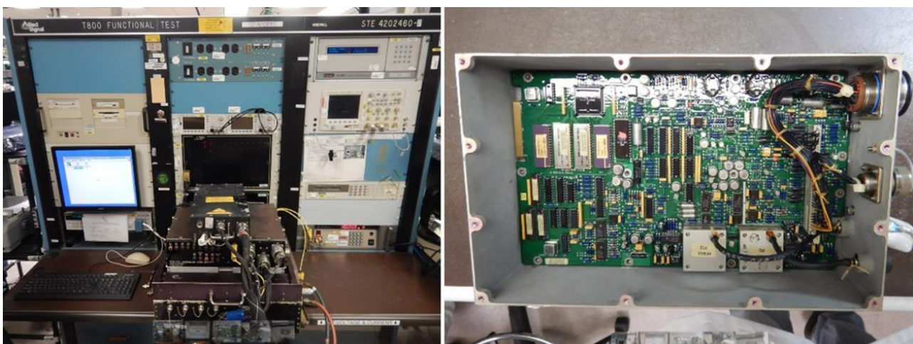
Figura 8. Proceso de extracción de datos de las DEEC. Fuente: Honeywell Aerospace
