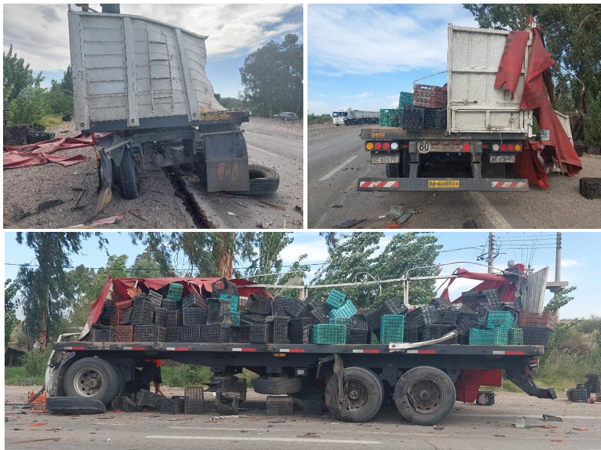
Figura 6. Daños materiales del acoplado del Vehículo 1. Se observa el sector anterior, lateral izquierdo y sector posterior afectados. Fuente: JST, 2024
