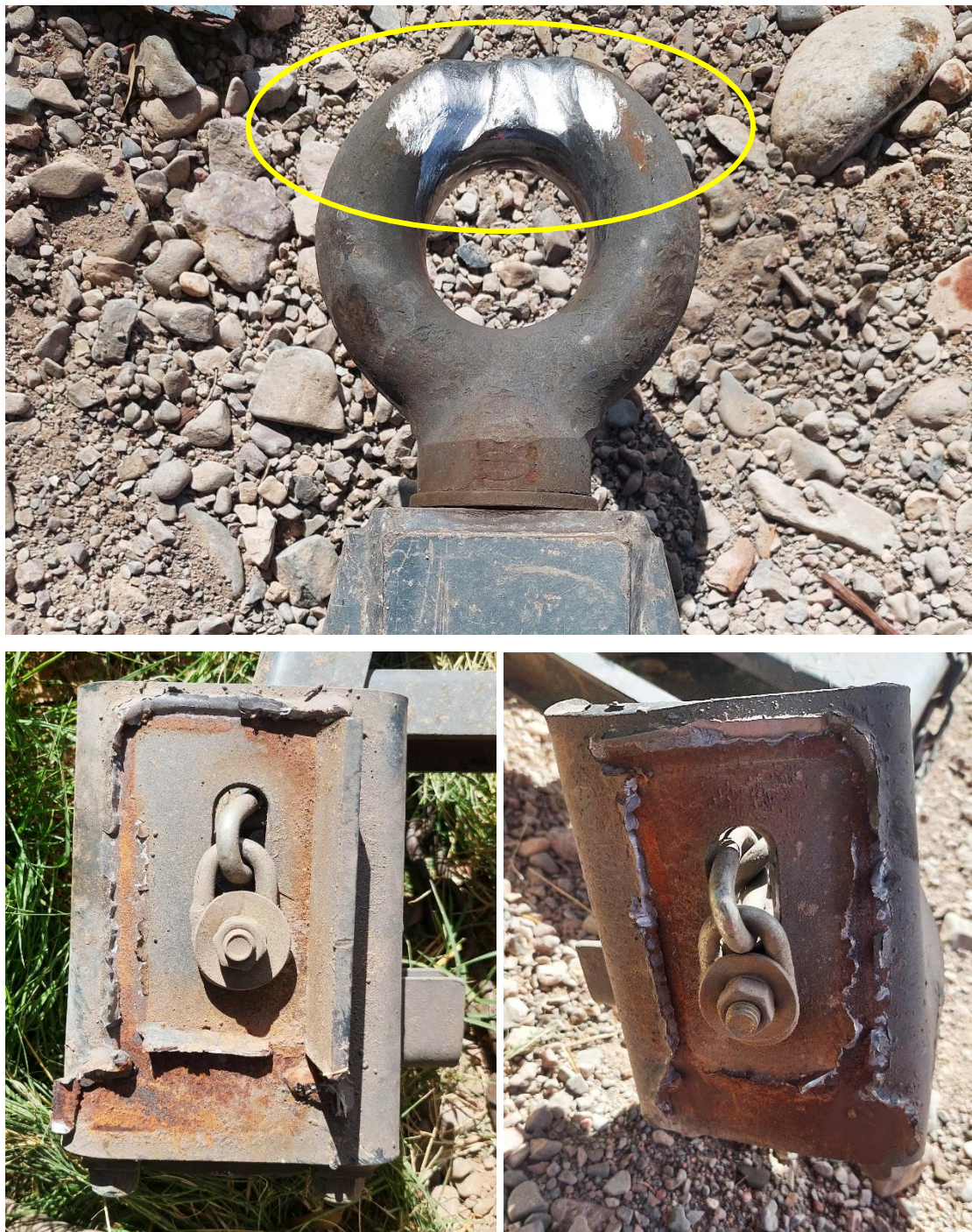
Figura 12. Extremos de la lanza. En la fotografía de arriba y dentro del óvalo, se observa el ojal de enganche con desgaste excesivo por fricción. En las fotografías de abajo, se observan los extremos solidarios al acoplado con signos de fractura por tracción. Fuente: JST, 2024
