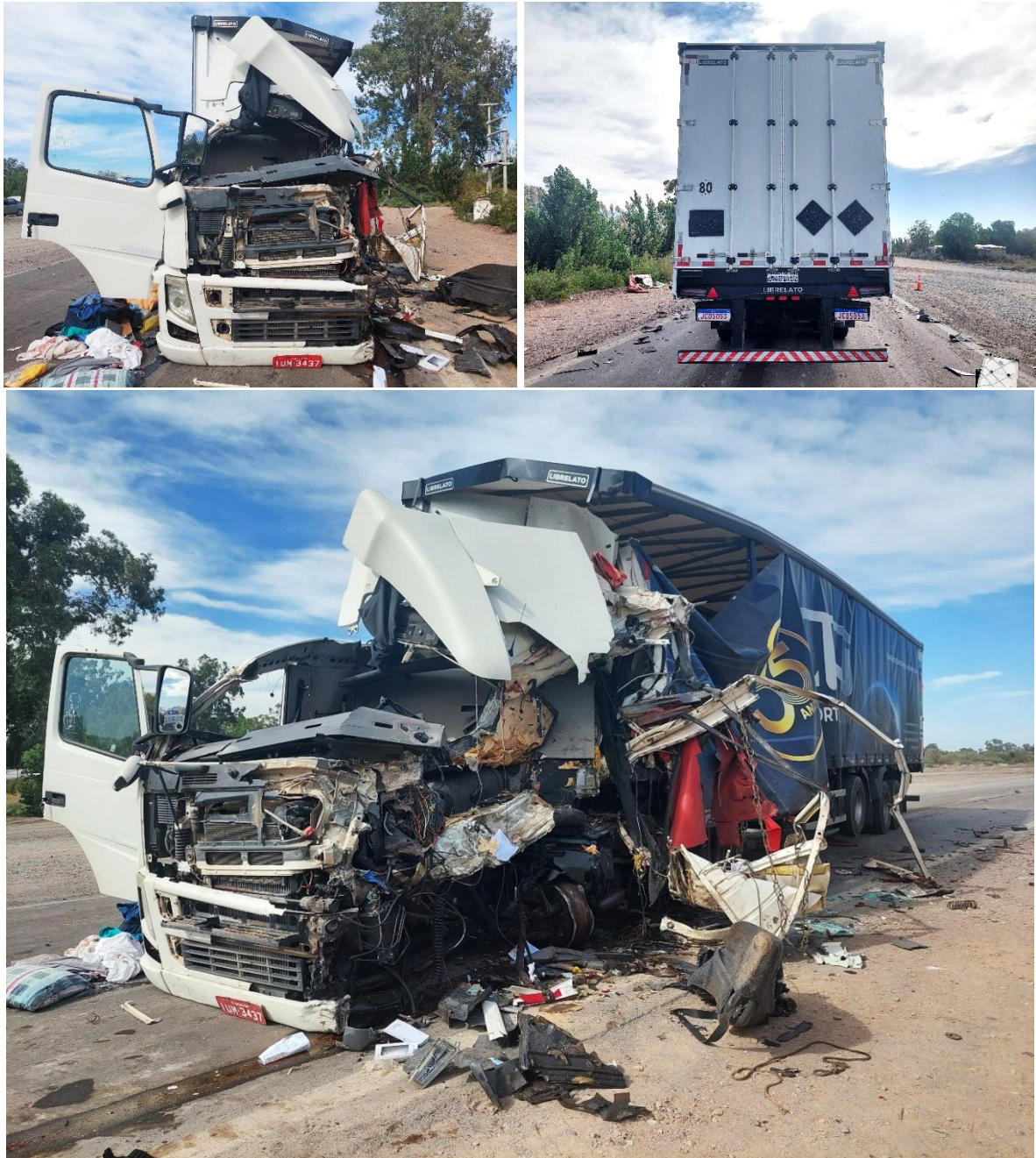
Figura 8. Daños materiales del Vehículo 2. Se observa el sector anterior y lateral izquierdo afectados, en especial zona del habitáculo del conductor. Fuente: JST, 2024
