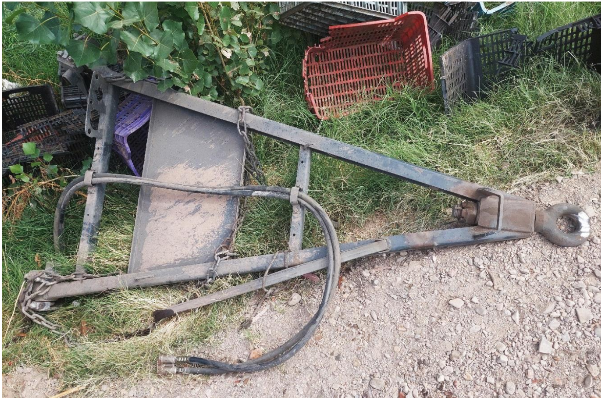
Figura 11. Lanza que une el acoplado con el camión tractor del Vehículo 1, completamente desprendido, a un costado de la vía. Fuente: JST, 2024
