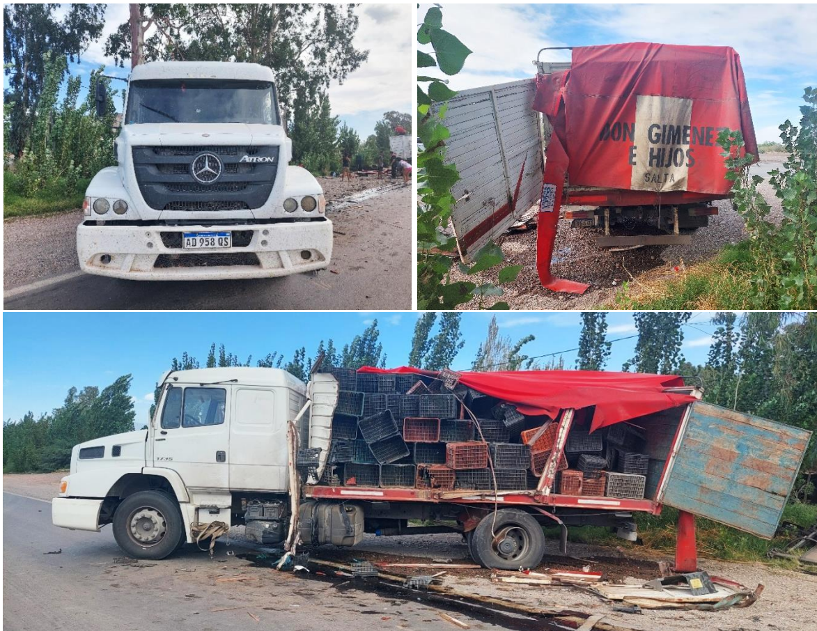
Figura 5. Daños materiales del camión tractor del Vehículo 1. Se observa el lateral izquierdo mayormente afectado. Fuente: JST, 2024
