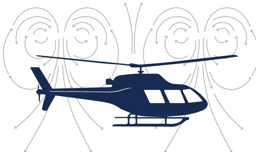
Figura 7. Anillos de vórtice en asentamiento con potencia
