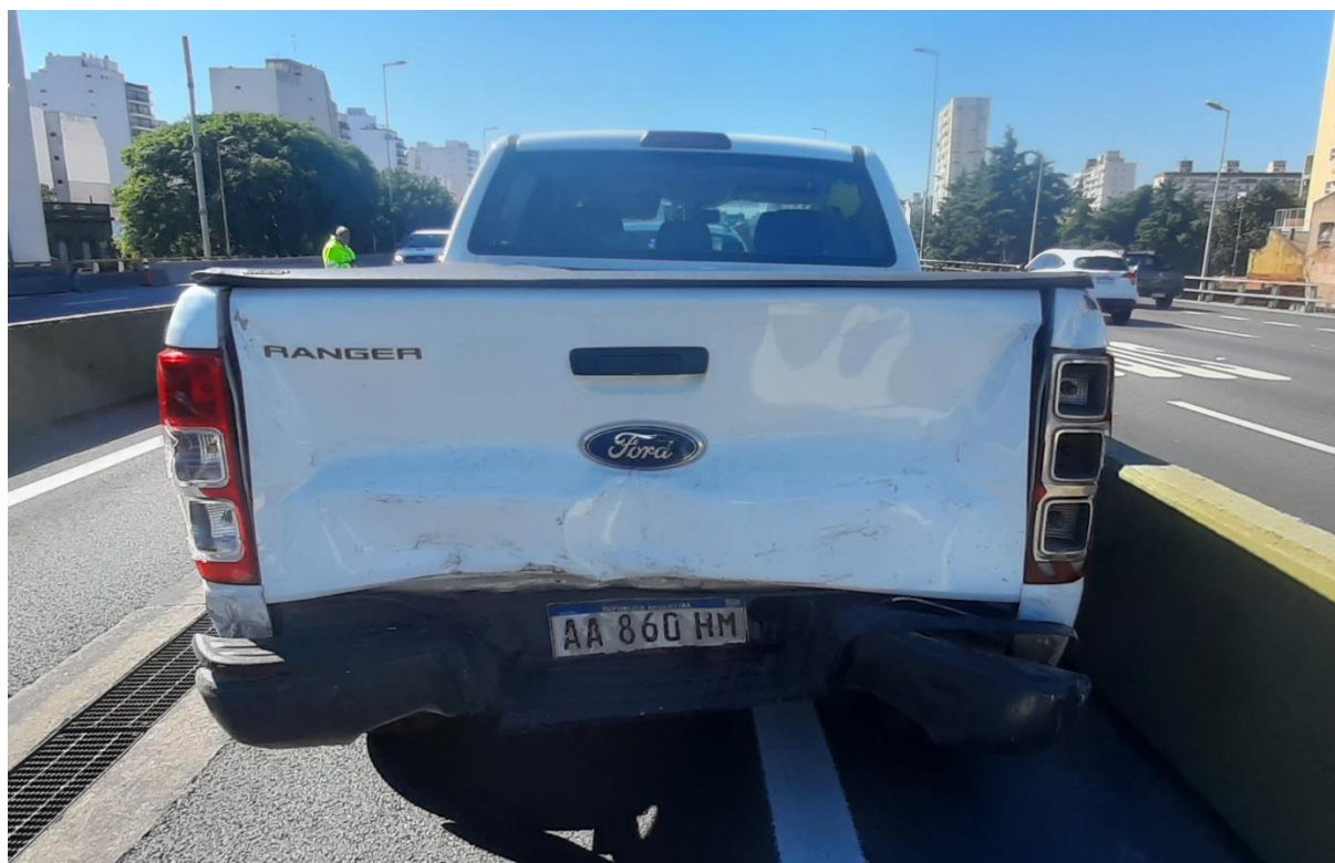
Figura 6. Daños en el sector posterior del Vehículo 2 ocasionados por la colisión con el Vehículo 3.
