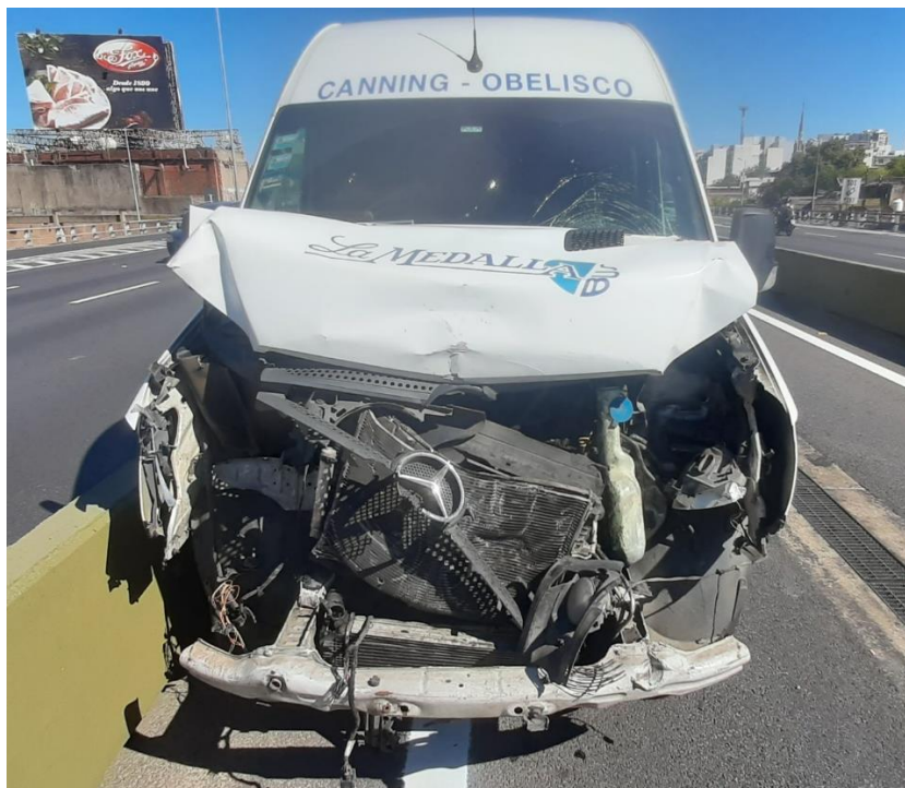
Figura 8. Daños ocasionados en la colisión por alcance con el Vehículo 2. Fuente: JST, 2024
