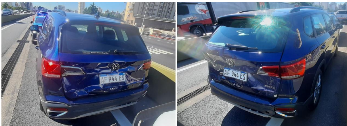
Figura 4. Daños ocasionados en la colisión por alcance con el Vehículo 2. Fuente: JST, 2024
