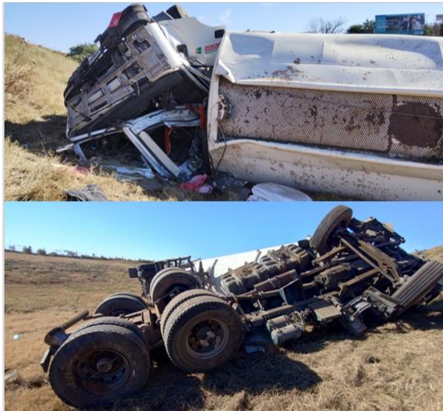
Figura 7. Daños materiales en el camión tractor. Se observan daños generales en su estructura pos vuelco. Fuente: JST, 2024
