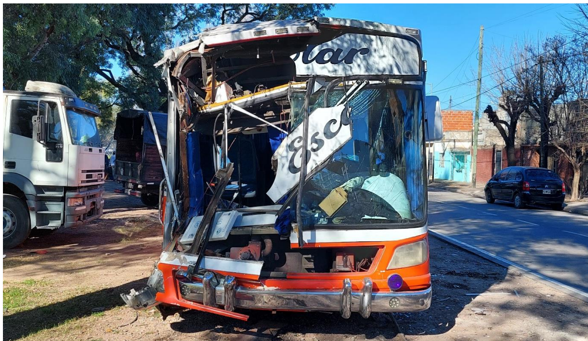
Figura 11. Daños en el sector anterior producto de la colisión con el Vehículo 1. Fuente: JST, 2024
