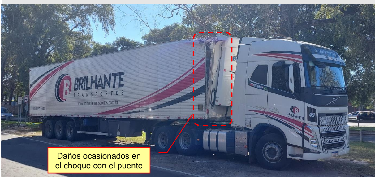
Figura 8. Daños en el sector derecho anterior del semirremolque. Sector anterior y lateral derecho del camión tractor sin deformaciones. Tercios central y posterior derechos del semirremolque sin daños ocasionados en el suceso. Fuente: JST, 2024
