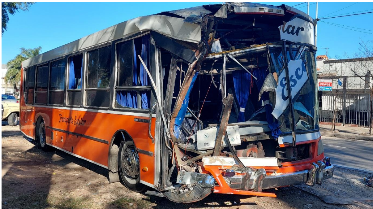
Figura 12. Daños indirectos en el lateral derecho. Fuente: JST, 2024
