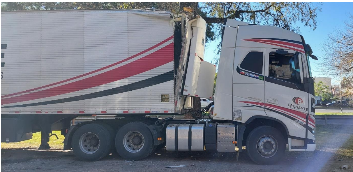
Figura 9. Detalle de las deformaciones en el sector anterior del semirremolque. Fuente: JST, 2024
