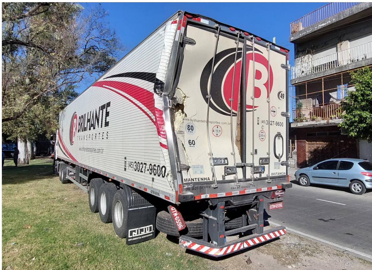
Figura 10. Daños en el sector posterior y lateral izquierdo del semirremolque a causa de la colisión con el Vehículo 2. Fuente: JST, 2024
