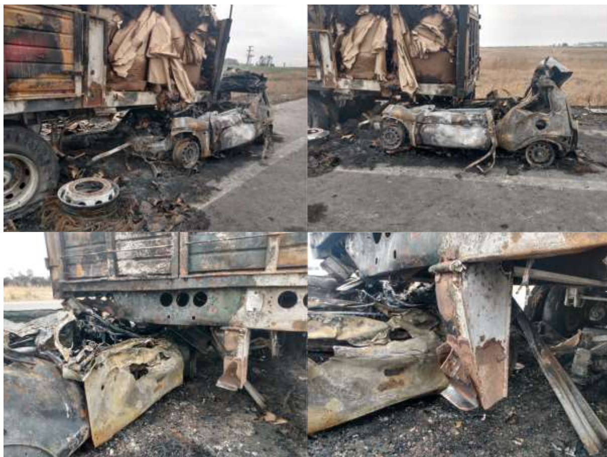
Figura 7. Detalle de algunos daños constatados en el Vehículo 2. Fuente: JST, 2024
