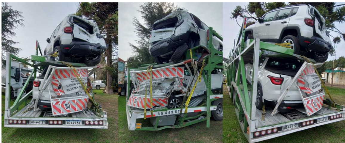
Figura 8. Daños en el semirremolque del Vehículo 2. Fuente: JST, 2024
