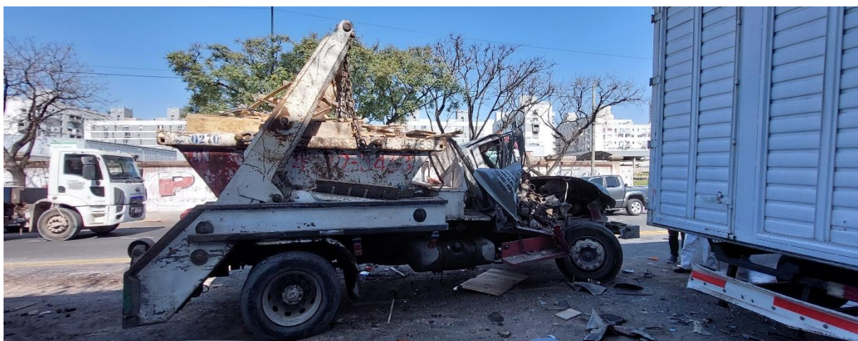
Figura 8. Daños en el lateral derecho del Vehículo 2. Fuente: JST, 2024
