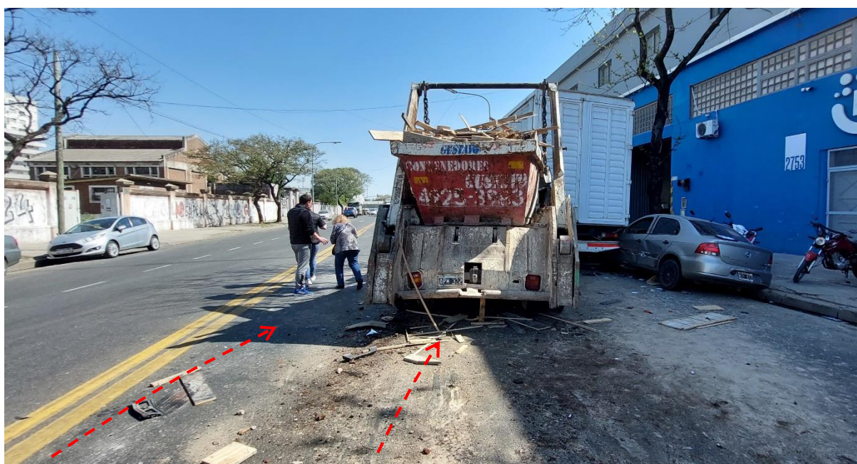
Figura 20. Finalización de las huellas de frenado posimpacto del Vehículo 1. Fuente: JST, 2024
