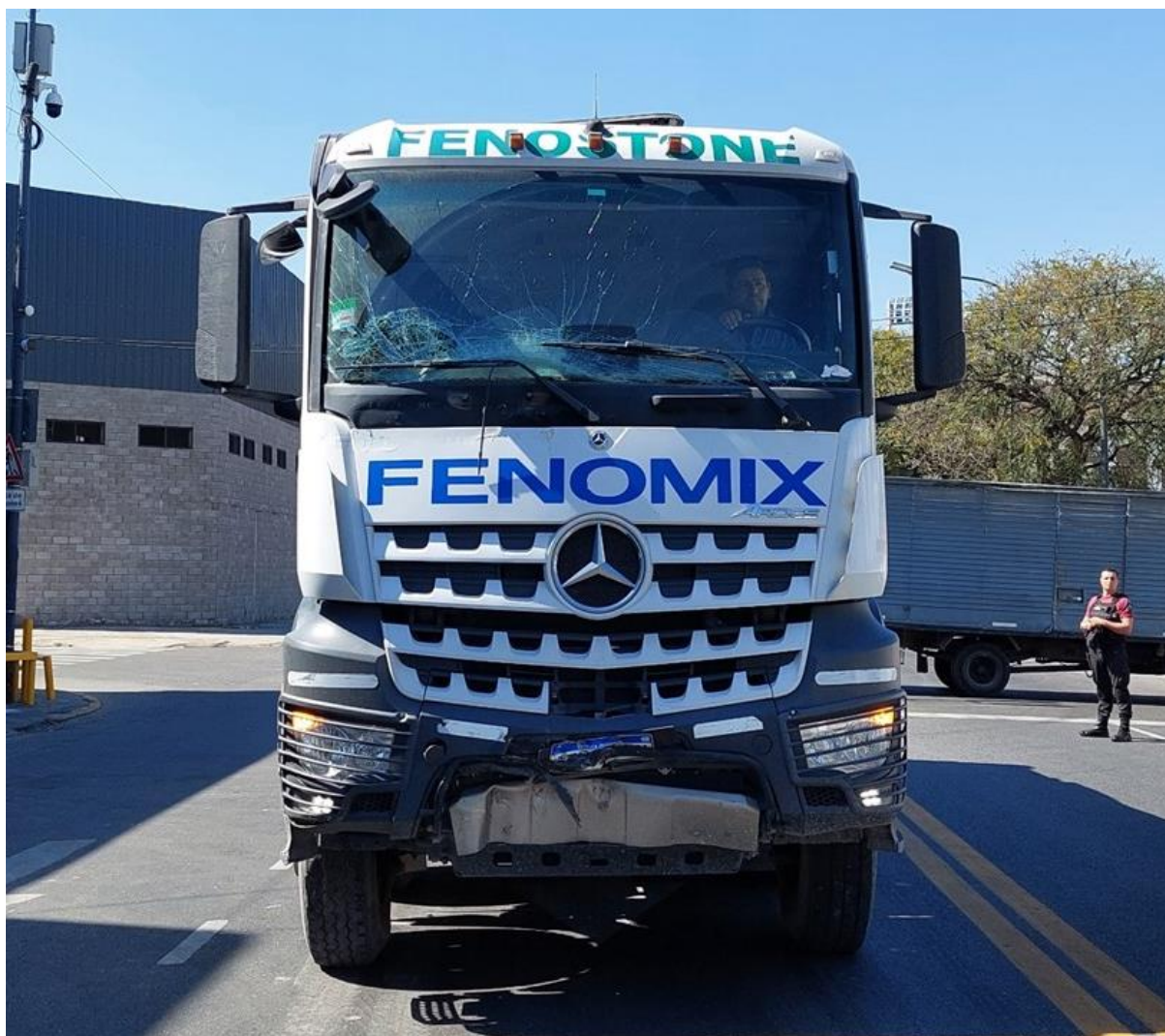
Figura 5. Daños producidos en el Vehículo 1 por el impacto con el Vehículo 2. Fuente: JST,2024
