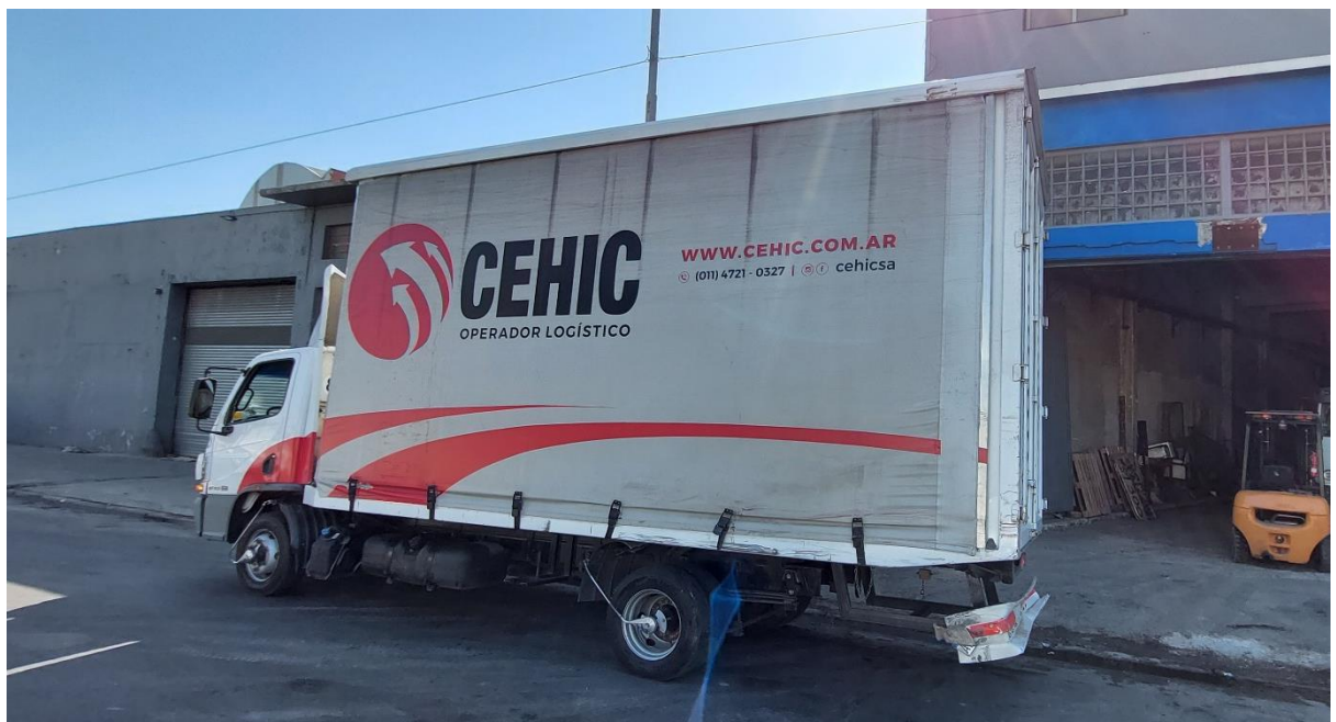
Figura 11. Daños en el Vehículo 3 producto de la colisión con el Vehículo 2. Fuente: JST, 2024
