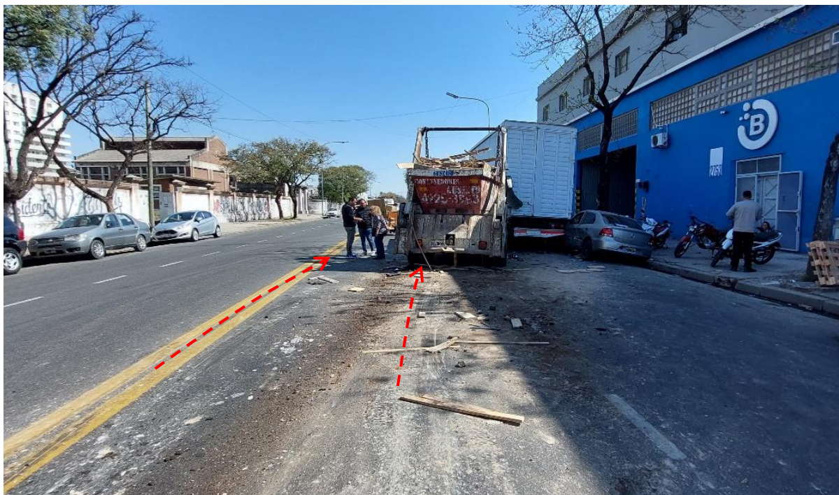
Figura 18. Huellas de frenado posimpacto del Vehículo 1 con una longitud de 4,7 m. Fuente: JST, 2024
