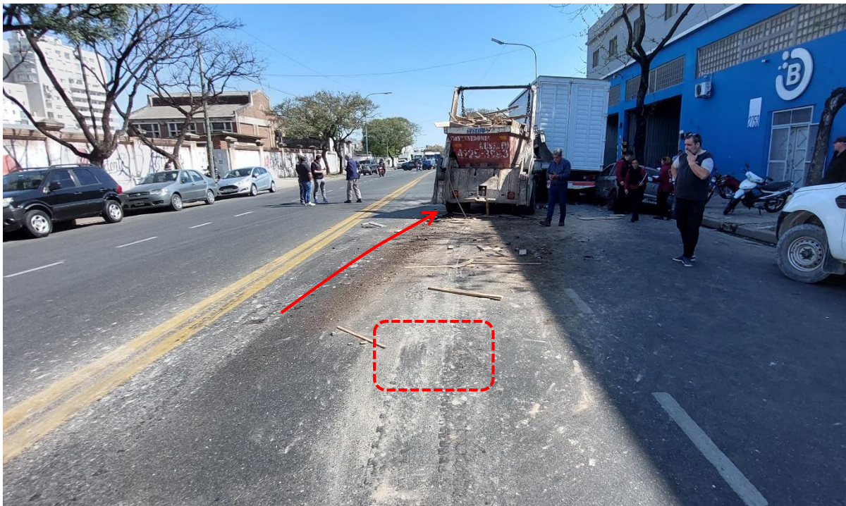
Figura 17. Zona de choque entre los vehículos 1 y 2, evidenciada por las huellas del tipo brochazo y el inicio del desperdigamiento de material trasladado por el Vehículo 2. Fuente: JST, 2024
