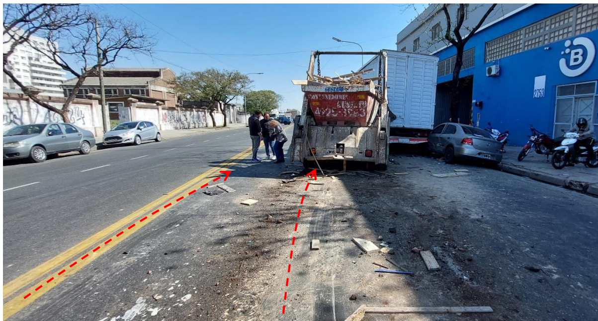
Figura 19. Continuación de las huellas de frenado posimpacto del Vehículo 1. Fuente: JST, 2024
