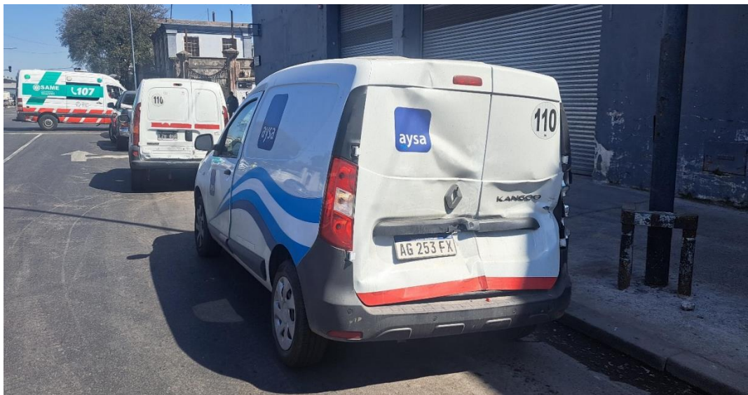
Figura 13. Daños en el sector posterior del Vehículo 4 producidos por el choque con el Vehículo 2.
