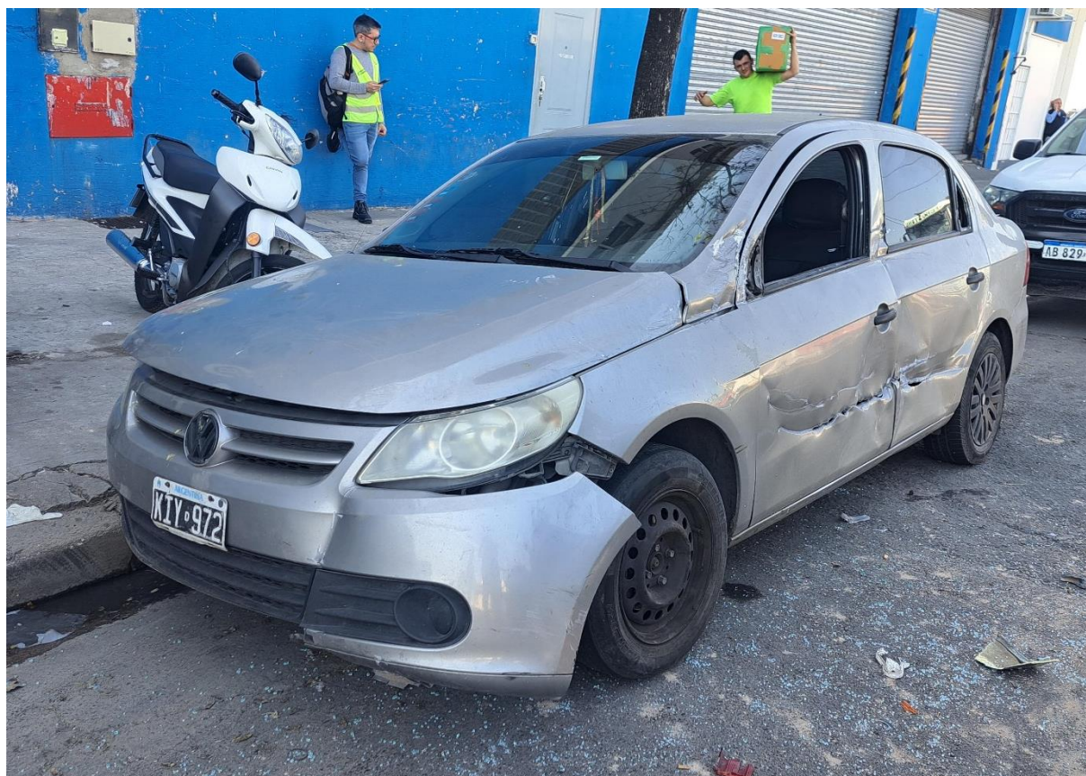
Figura 15. Daños en el lateral izquierdo del Vehículo 6 causados por el choque con el Vehículo 3.
