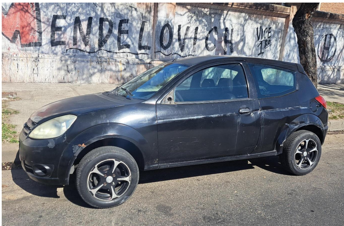
Figura 16. Daños en el lateral izquierdo del Vehículo 7 causados por el choque con el Vehículo 3.
