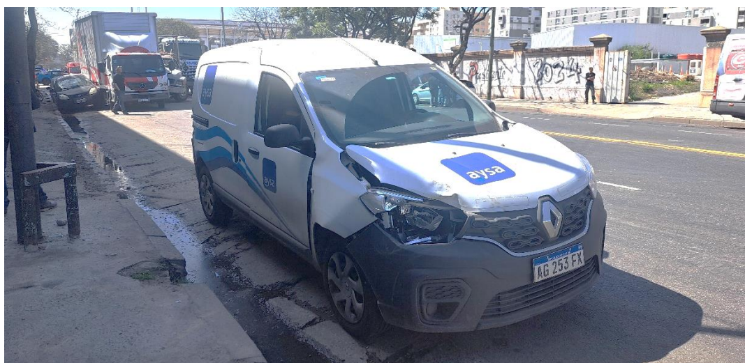
Figura 14. Daños en el sector anterior del Vehículo 4 causados por el choque con el Vehículo 5.
