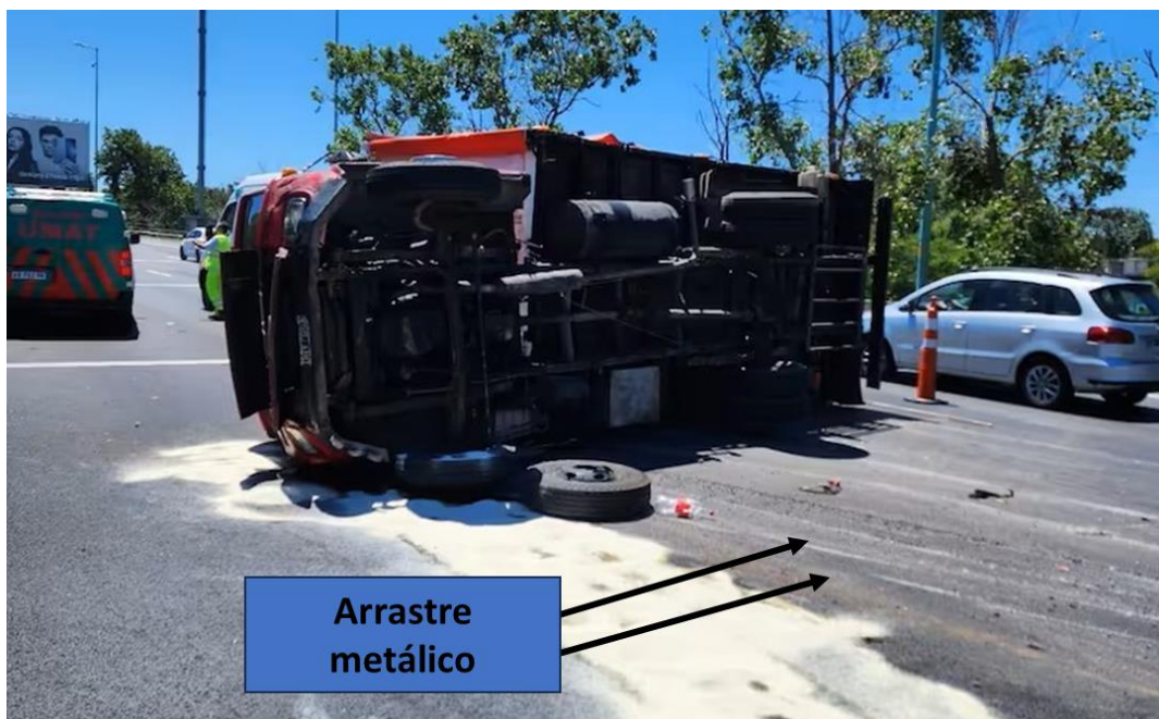
Figura 16. Arrastre metálico presente en la calzada. Fuente La Nación , 2023
