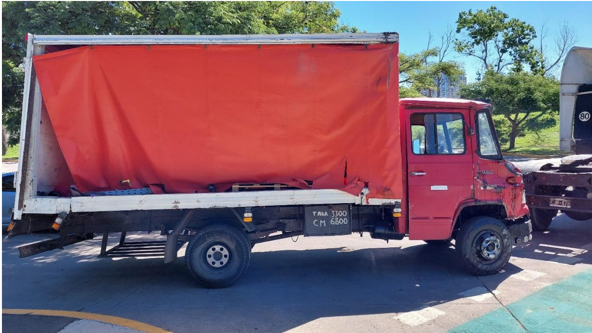
Figura 10. Daños en la estructura de la caja. Fuente JST, 2023
