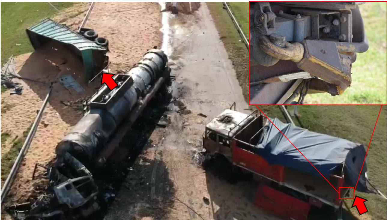
Figura 12. Vehículo 2, detalle de daños y dirección de los impactos demarcados con las flechas. Recuadro superior con detalle de la lanza del acoplado. Fuente: JST.
