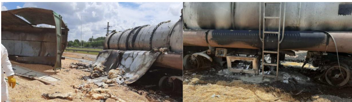
Figura 4. Detalle de daños del tanque cisterna del Vehículo 1
