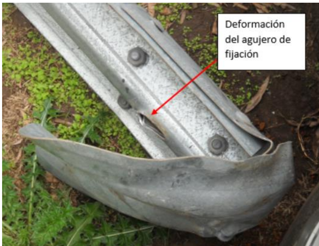
Figura 13. Tramo de la barrera desprendido. Fuente: JST, 2021
