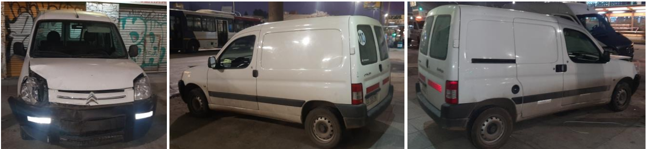
Figura 7. Daños en el paragolpes, capó y óptica delantera derecha del Vehículo 3. Fuente: JST, 2021.
