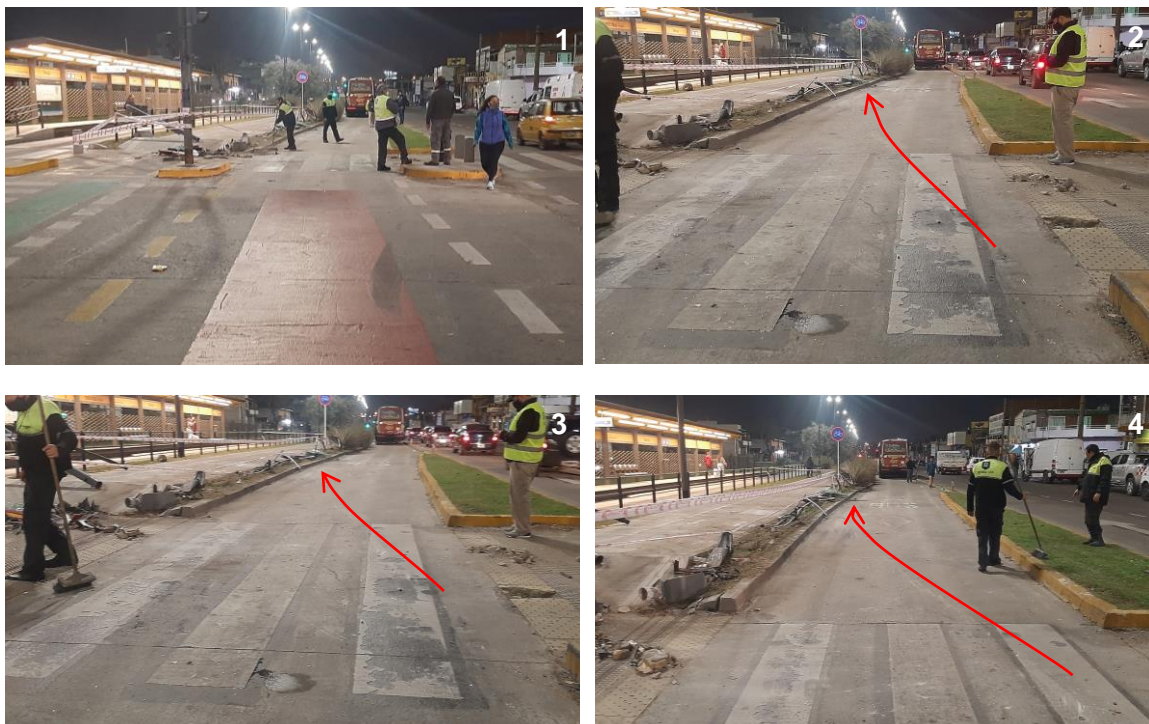
Figura 8. Cuatro fotografías que muestran huella del tipo brochazo del Vehículo 2 y efracciones posimpacto del Vehículo 1 y daños en estructura edilicia. Fuente: JST, 2021.
