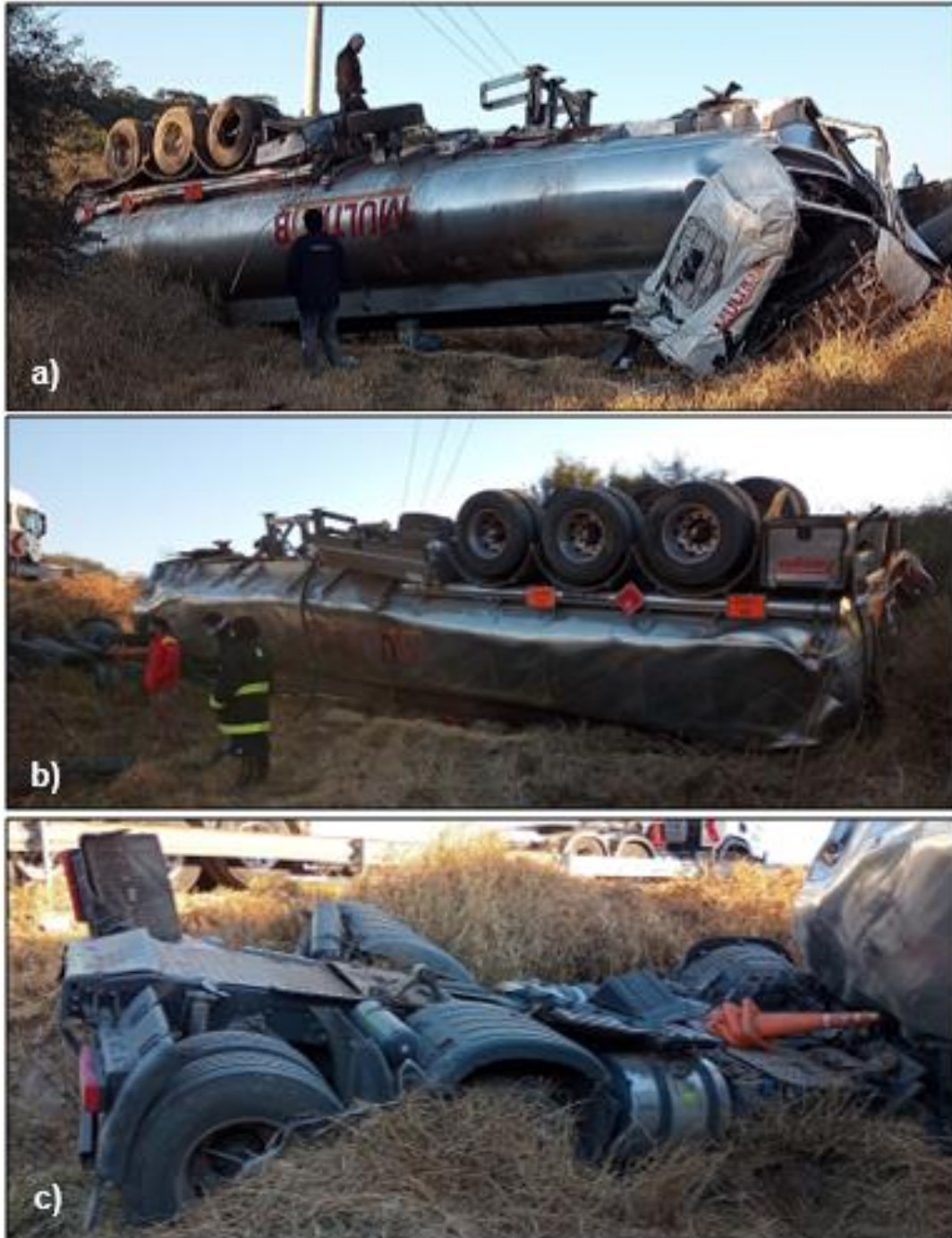
Figura 7. Imágenes de los daños del vehículo: a) cabina y lateral izquierdo de cisterna; b) lateral derecho de cisterna y c) bastidor de la unidad tractora separada de la cabina. Fuente: JST.
