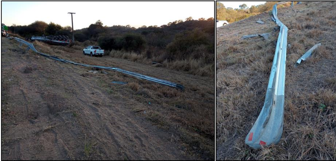
Figura 10. c) Zona del primer impacto entre el sector izquierdo del camión y la barrera; d) Extremo de la barrera arrancada del piso y lanzada hacia la zona de préstamo, con huellas de fricción. Fuente: JST.
