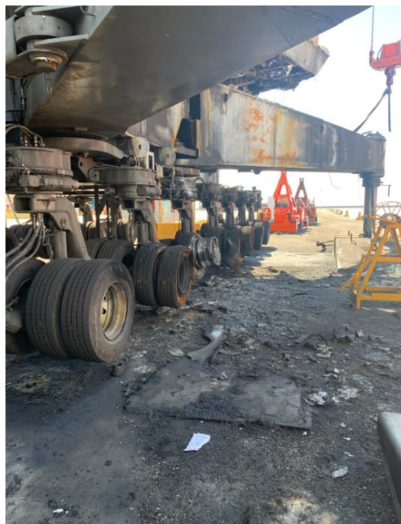
Figura 20. Vista lateral, zona baja con restos de material quemados.
