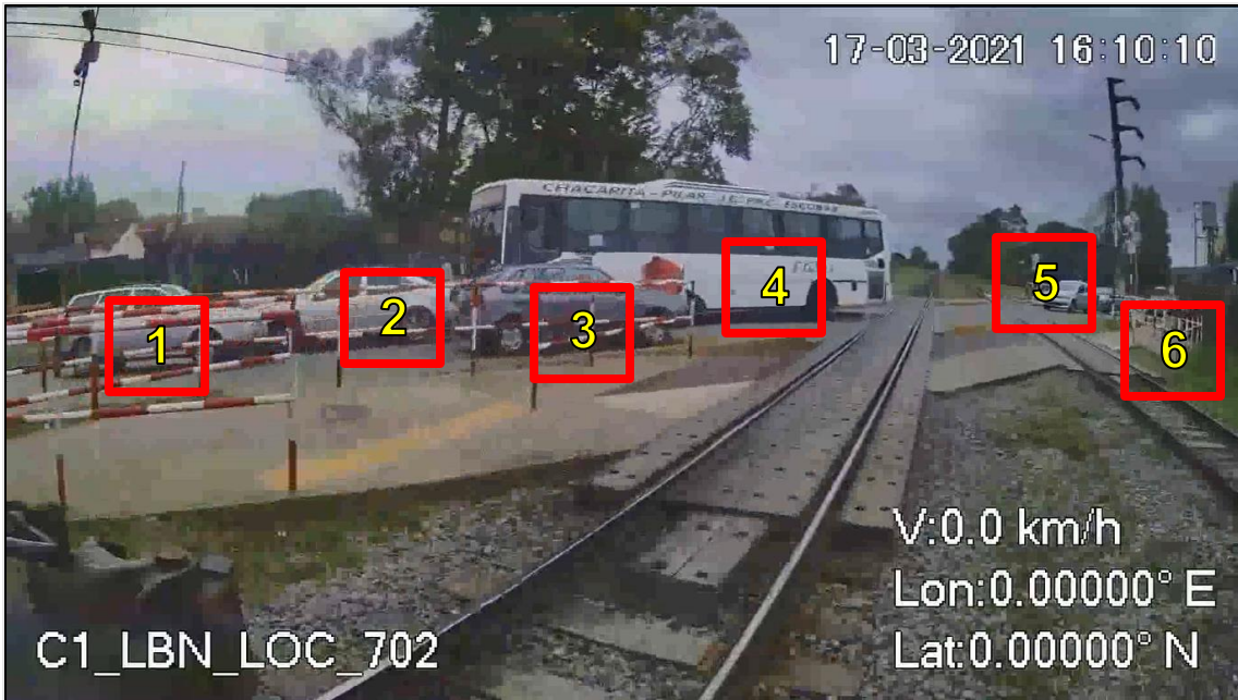
Figura 13. Vehículos invadiendo la zona de vía
