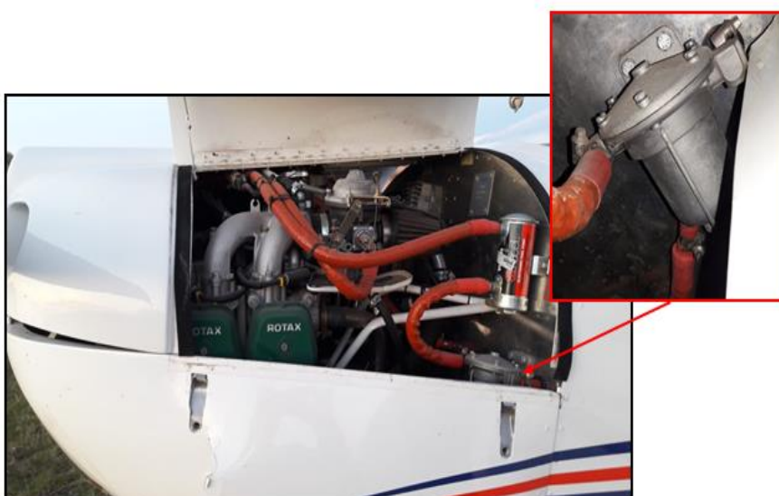
Figura 7. Colector del filtro de combustible
