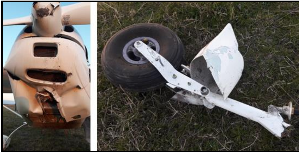
Figura 2. Daños en carenados de motor y tren de aterrizaje de nariz
