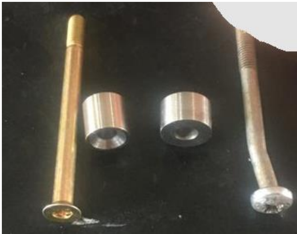
Figura 3. Comparación entre tornillo y buje original (izquierda) y los utilizados (derecha)
