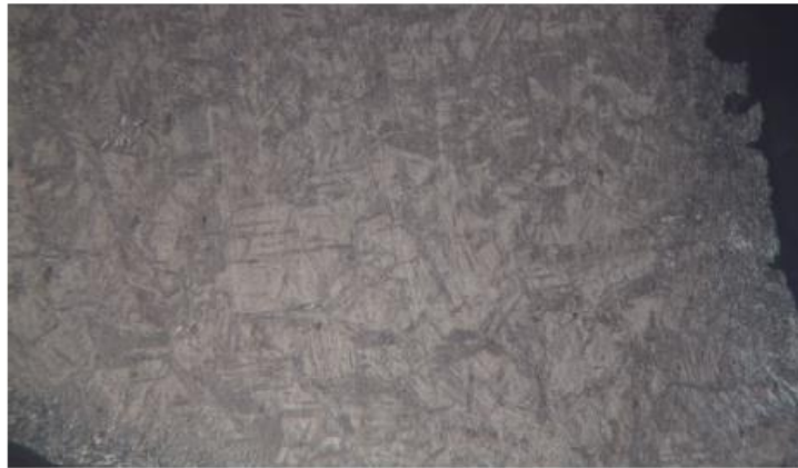
Fotomicrografía n°5 – x 100 aumentos – Corte B-B
