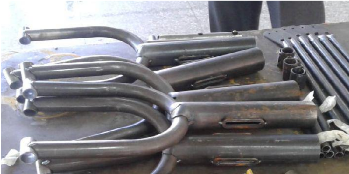
Figura 7. Horquillas de tren de nariz en construcción
