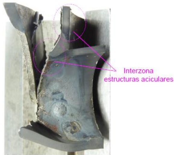
Fotografía n°14 – probeta metalográfica corte A-A-
