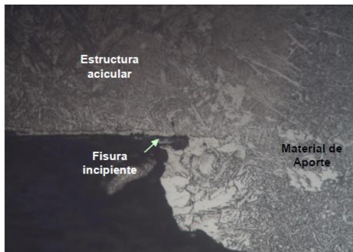
Fotomicrografía n°4 – x 200 aumentos – Fisura incipiente
