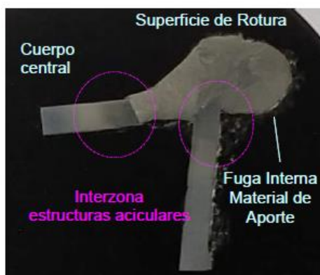
Fotografía nº13 – probeta metalográfica corte A-A-
