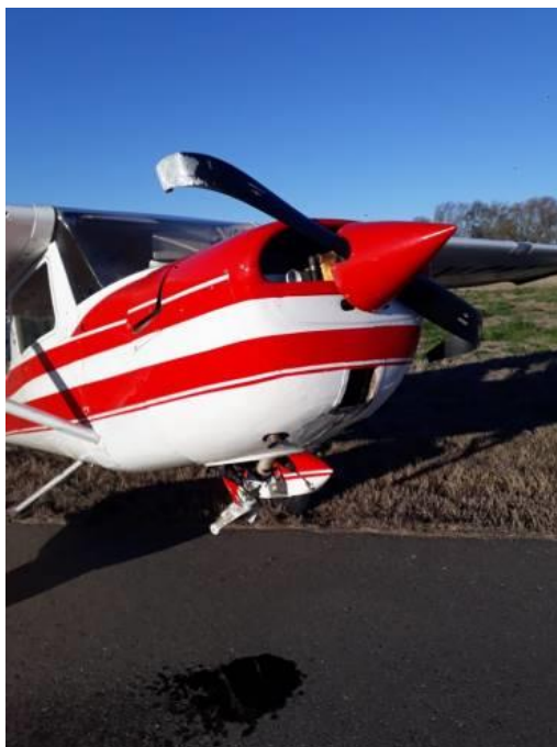
Figura 1. Imagen de los daños en el LV-CMY
