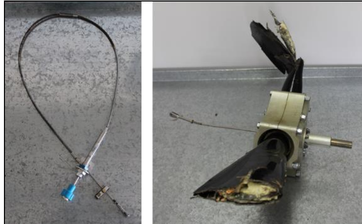
Figura 4. Comando de paso de hélice y cubo de hélice
