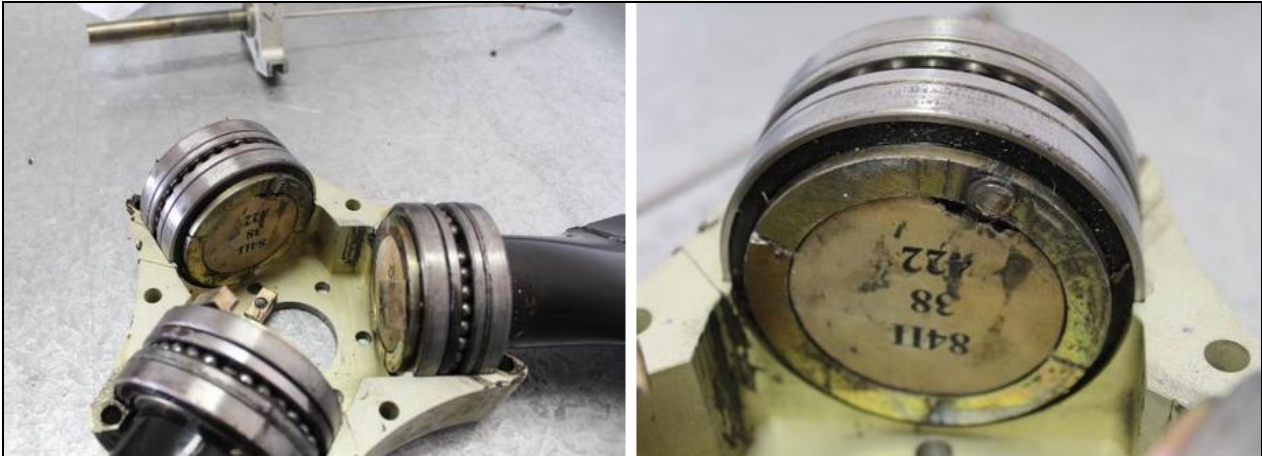
Figura 6. Desarme del cubo de hélice y perno de pivót dañado
