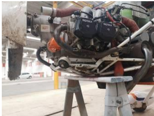
Figura 5. Daños en el filtro de aceite y en el escape
