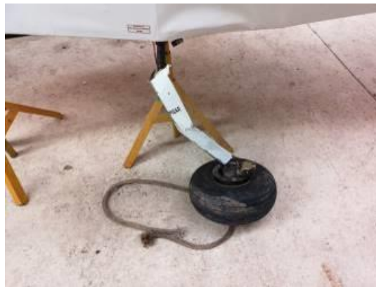
Figura 4. Daños en el tren de aterrizaje izquierdo
