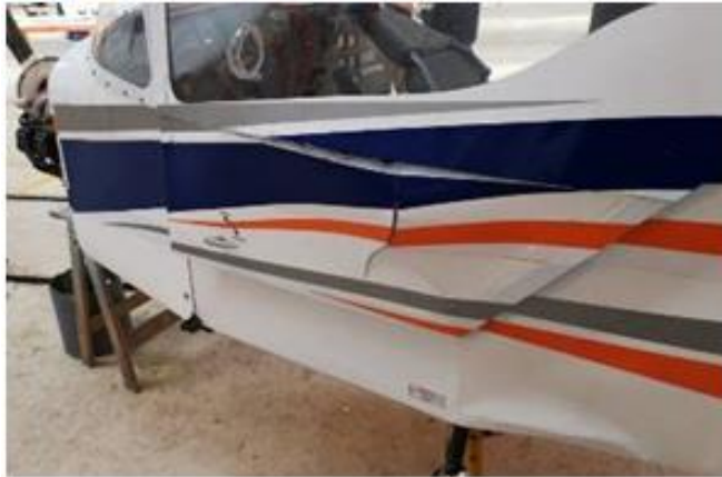
Figura 2. Daños en el lateral del fuselaje y en la puerta izquierda
