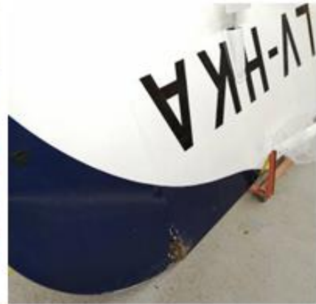
Figura 3. Daños en el ala izquierda
