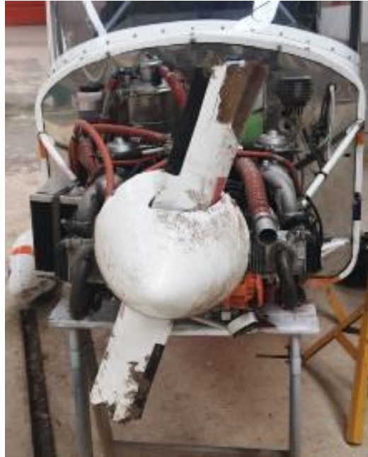
Figura 6. Daños en la hélice
