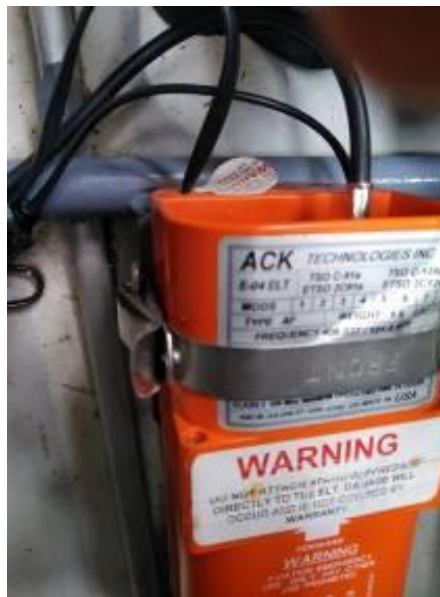
Figura 9. Equipo ELT instalado
