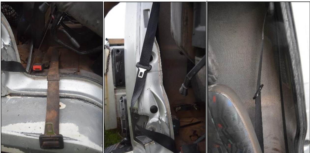
Figura 8. Estado de los cinturones de seguridad del vehículo. Fuente: JST, 2021.
