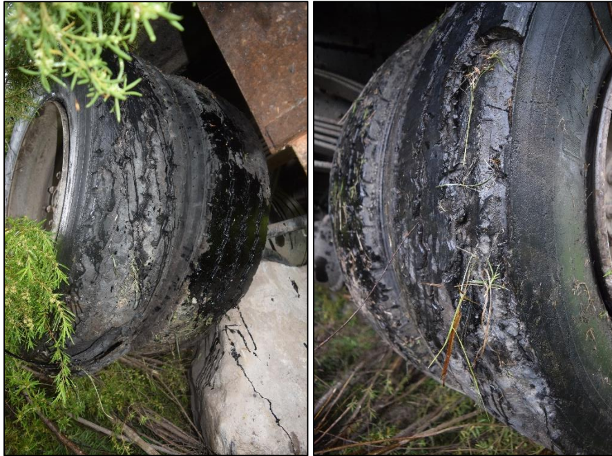
Figura 7. Fotografías de los neumáticos dañados del camión. Fuente: JST, 2021.
