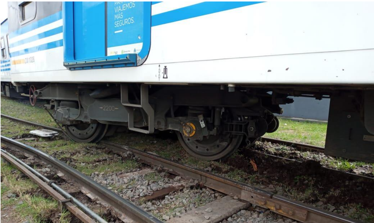
Figura 3. Detalle del bogie n°1 descarrilado. Fuente: Archivo JST
