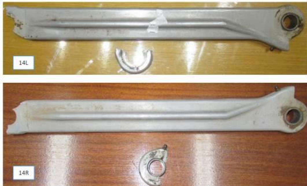
Imagen N°3 – Estado de recepción de conjunto Drag Brace fuera del embalaje
