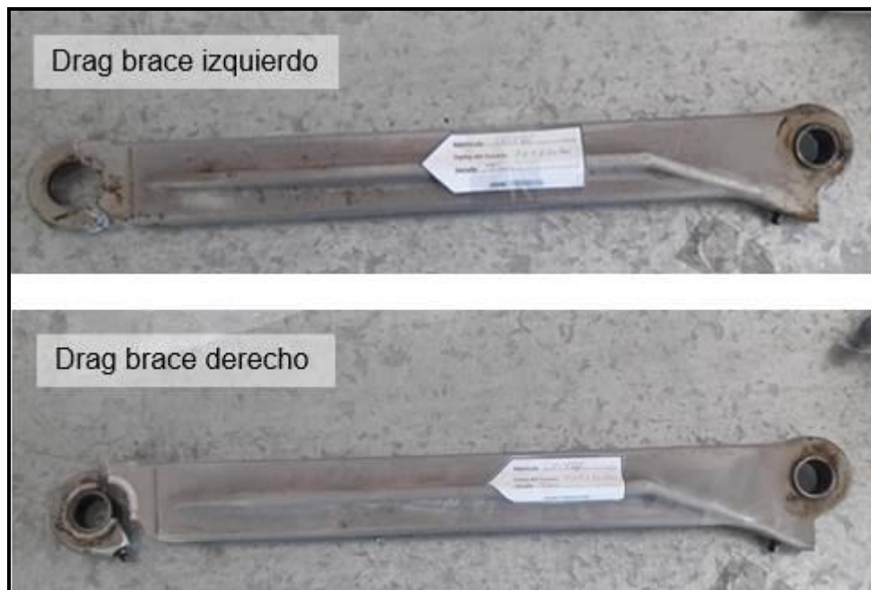
Figura 4. Imagen de las partes fracturadas
