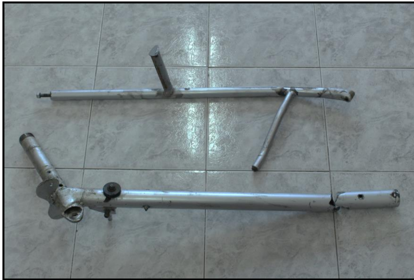
Figura 9. Estructura del tren de aterrizaje principal derecho
